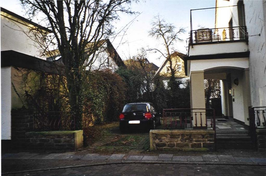
Abb. Positiv - Erhöhung der kleinklimatisch wirksamen Grünfläche durch Fassadengrün und versickerungsfähigen Stellplatz(Rasenfugenpflaster)
