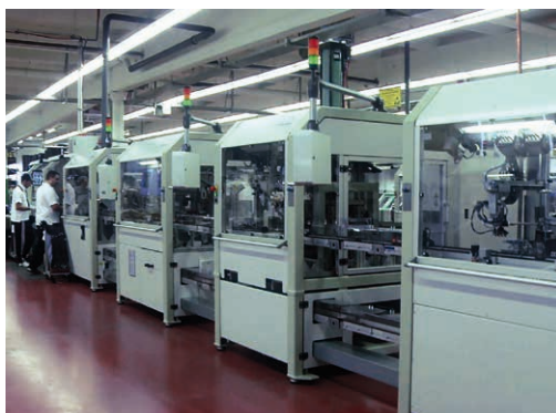
Hochautomatisierte Produktionslinie der PV-Modul-Anschlussdosen
