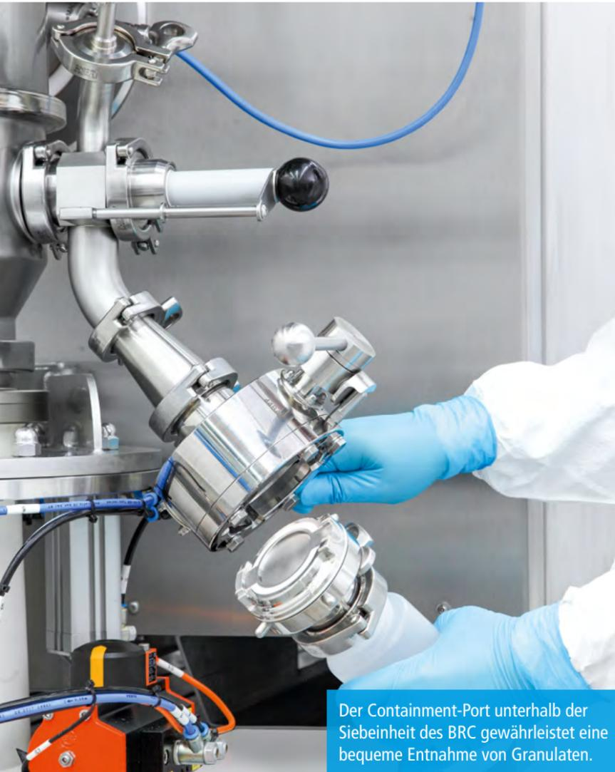
Der Containment-Port unterhalb der Siebeinheit des BRC gewährleistet eine bequeme Entnahme von Granulaten.
