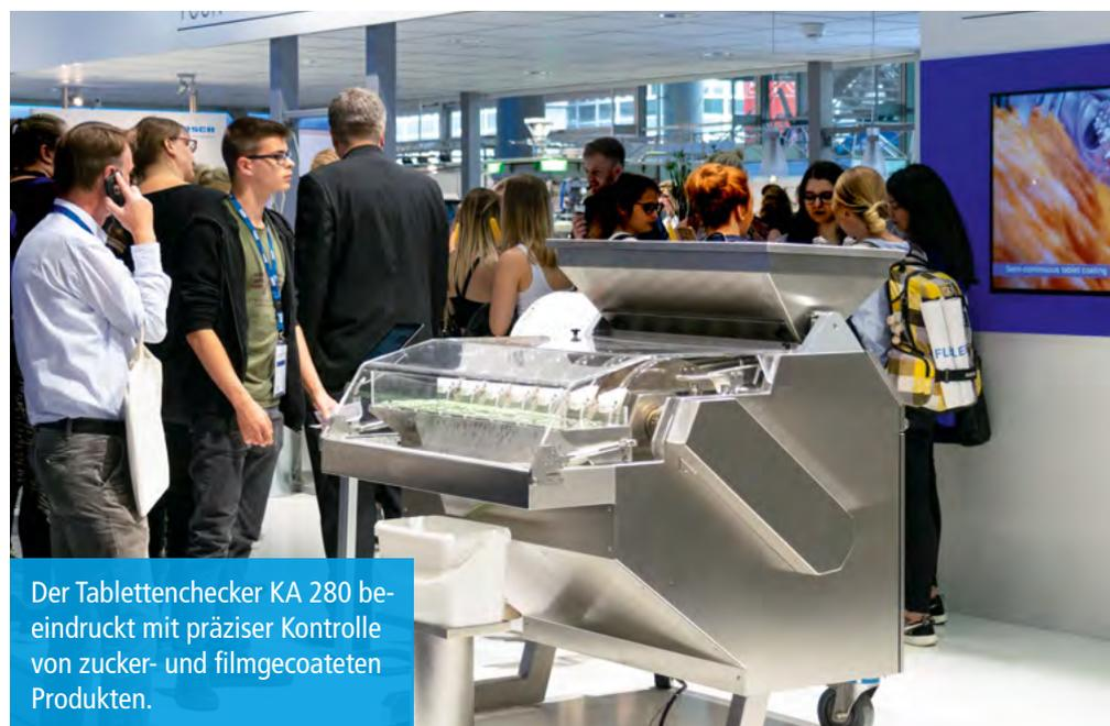
Der Tablettenchecker KA 280 beeindruckt mit präziser Kontrolle von zucker- und filmgecoateten Produkten.
