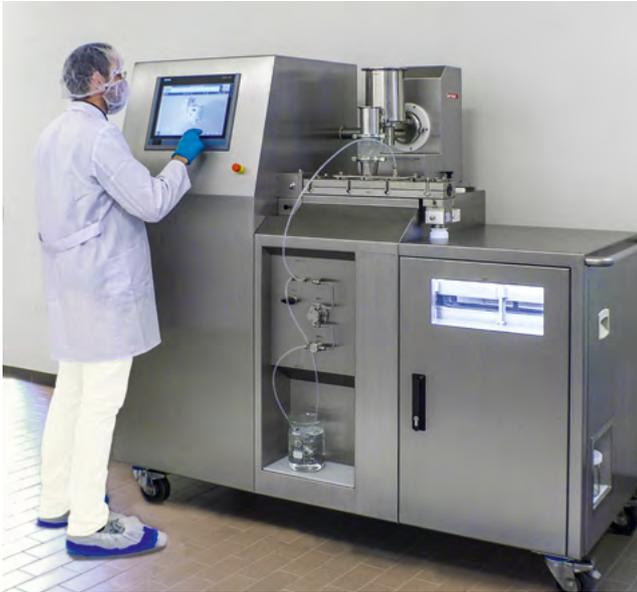
Die Förderung der Granulate und der Luftstrom sind unabhängig voneinander einstellbar. Dadurch wird die Trocknungswirkung der Granulate über die Zulufttemperatur, die Zuluftmenge und die Fördergeschwindigkeit geregelt.
