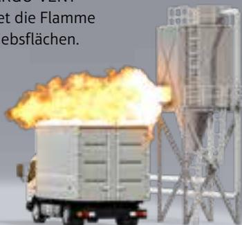
Mit TARGO-VENT wird die Flamme in sichere Bereiche gelenkt.
