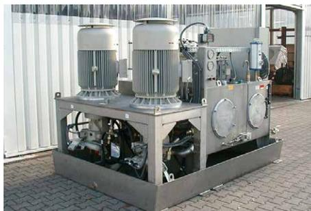
Hydraulikaggregat für Schleusenanlagen, komplette Edelstahl-Ausführung, mit Dieselmotor-Notaggregat.
