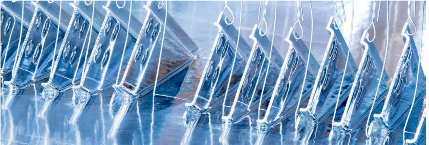
Verzinkte Stahlbauteile aus Gelsenkirchen: Beim Stückeverzinken werden die Teile in eine 450 Grad heiße Zinkschmelze getaucht. So erhalten sie Korrosionsschutz über viele Jahrzehnte. Foto: Carsten Paul
