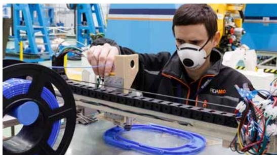
Mit 3-D-Druckern lassen sich dringend benötigte Teile für medizinische Ausrüstung produzieren. Foto: Airbus
