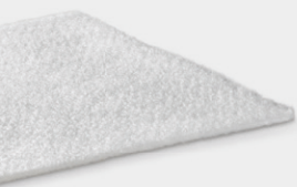
Secutex® H ist ein einlagiger oder mehrschichtiger, mechanisch verfestigter Spinnfaservliesstoff zum Trennen, Filtern, Schützen und Verpacken
