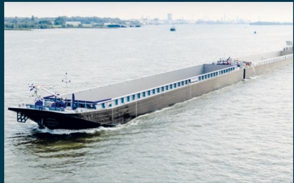
Die Zahlen sprechen für sich: Das 110 Meter lange und 11,45 Meter breite MS „Rhenus Duisburg“ hat einen Tiefgang von 3,20 Metern sowie eine Ladefähigkeit von 2.900 Tonnen
