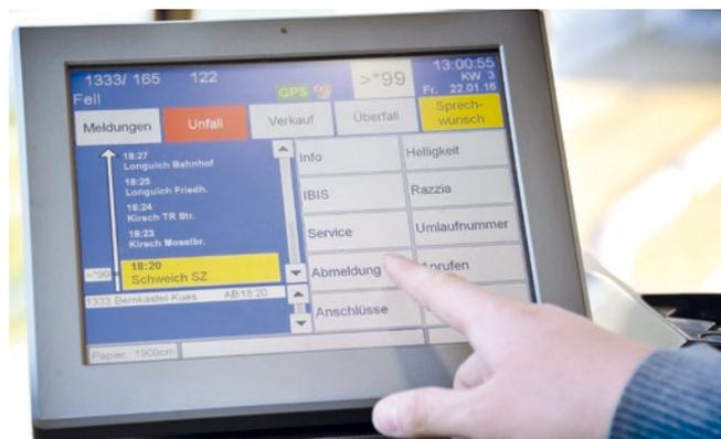
Intercambio de datos fácil y fiable en tan solo unos segundos: con unos pocos clics en la pantalla táctil, el conductor del autobús recibe información sobre las conexiones o los retrasos y puede expedir el billete adecuado. Así la comodidad es mayor y se ahorra tiempo al subir al autobús
