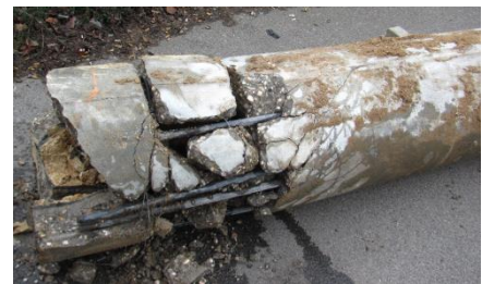
Austausch defekter Abspannmasten für die Seilverspannung
