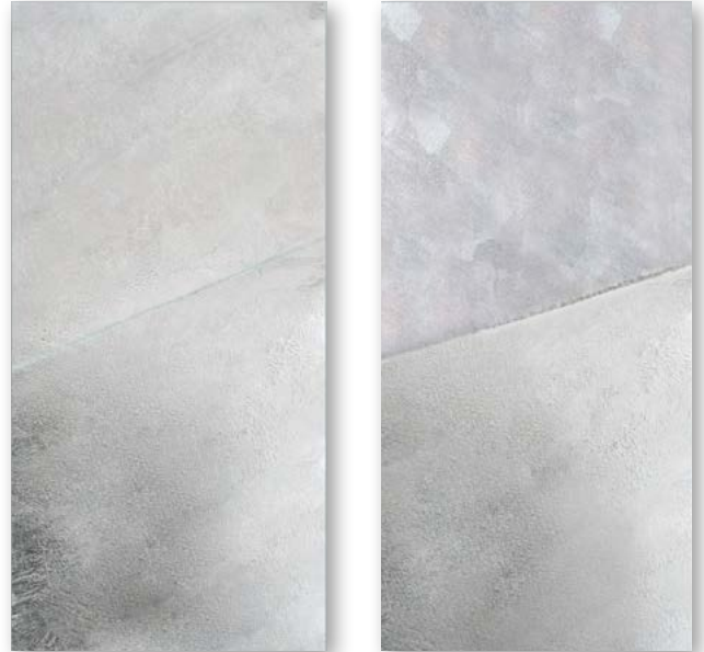
Nicht passiviertes / passiviertes Musterblech: links im Nullzustand, rechts nach 4 Wochen.
