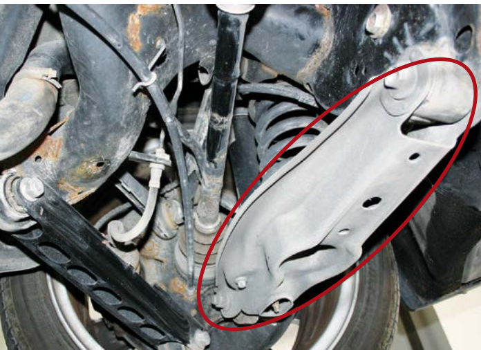
Bild 1: microZINQ®-Sturzenker: Unterfahrwerk-komponente nach 200.000 km.
