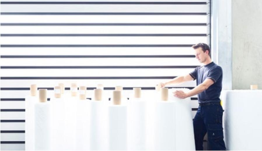
Der fertige Vliesstoff aus Meltblown-Material wird auf Rollen gewickelt und genutzt, um Atemschutzmasken herzustellen. Foto: Blumenbecker
