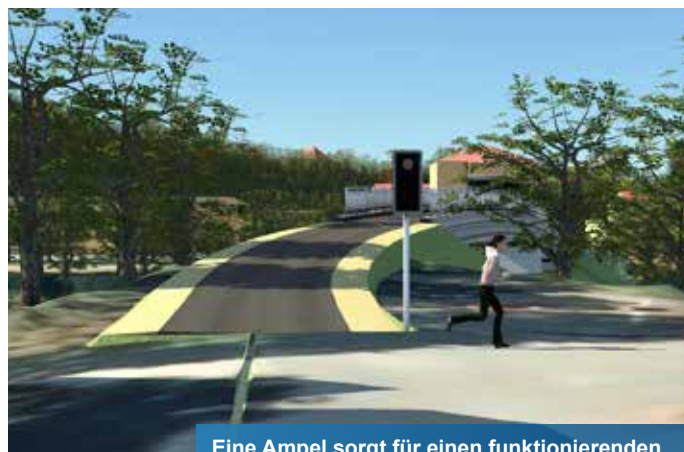
Eine Ampel sorgt für einen funktionierenden Verkehr in beide Fahrrichtungen.
