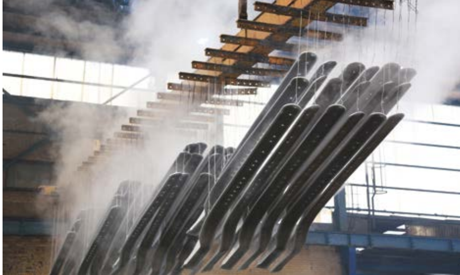
Energieintensive Produktion in der Verzinkung.
