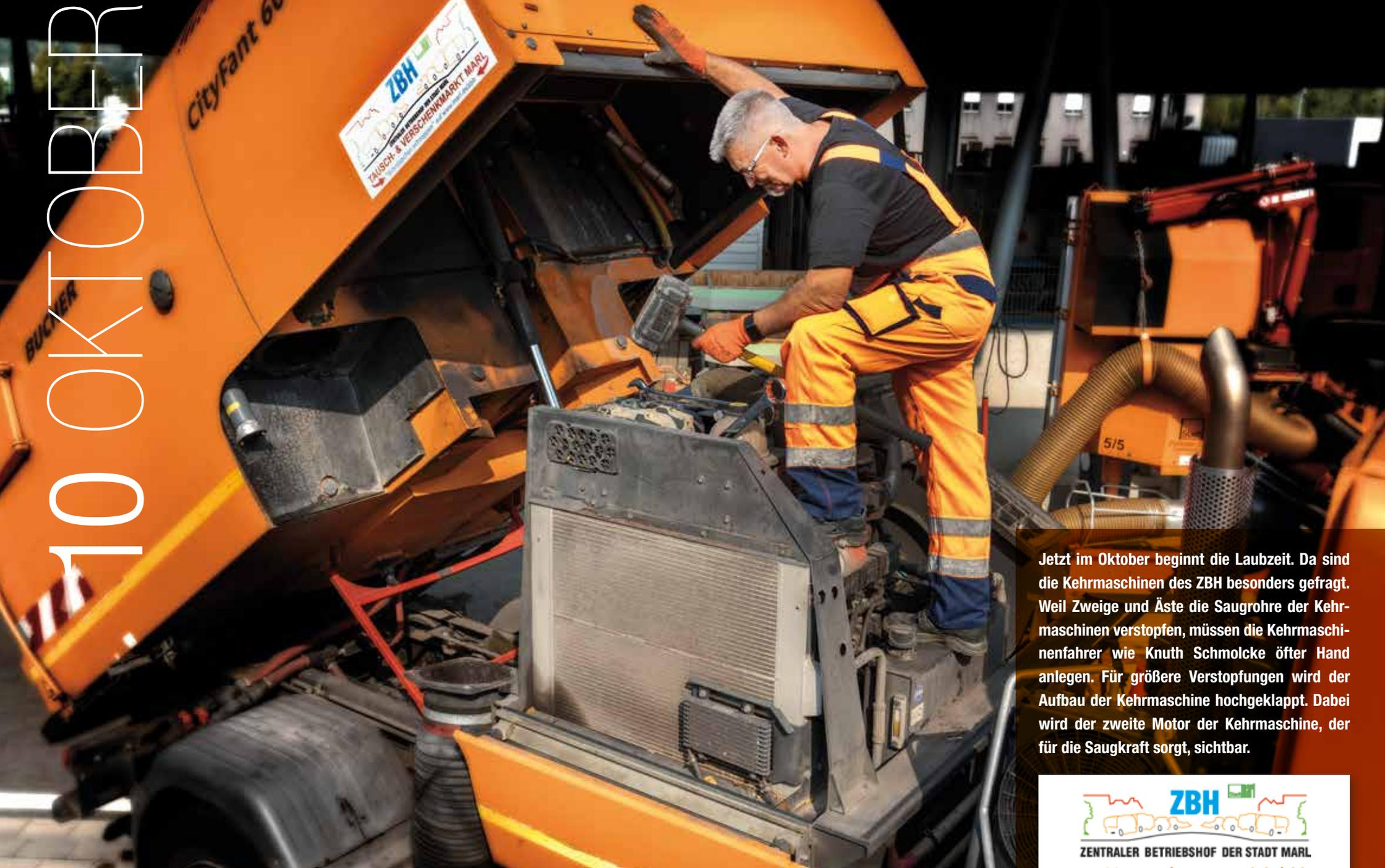
Jetzt im Oktober beginnt die Laubzeit. Da sind die Kehrmaschinen des ZBH besonders gefragt. Weil Zweige und Äste die Saugrohre der Kehrmaschinen verstopfen, müssen die Kehrmaschinenfahrer wie Knuth Schmolcke öfter Hand anlegen. Für größere Verstopfungen wird der Aufbau der Kehrmaschine hochgeklappt. Dabei wird der zweite Motor der Kehrmaschine, der für die Saugkraft sorgt, sichtbar.
