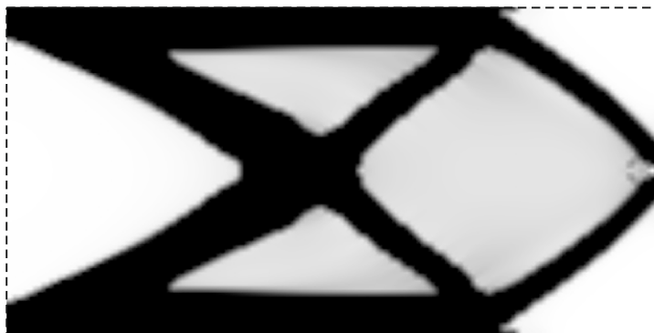
Abbildung 5.2.9.: Ergebnisse für den Biegebalken (Abb. 5.1.2, L = 2 ) für ein vorgegebenes Strukturvolumen von \varrho = 50\% und unterschiedlich feine Netze.
