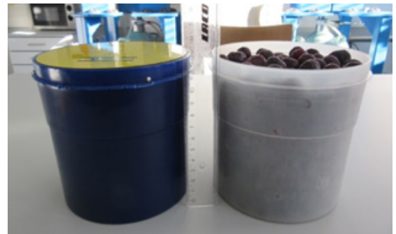
Abbildung 19 Probenbehälter für Gamma-Spektrometrie links: Aktivitätsnormal; rechts: Heidelbeerprobe
