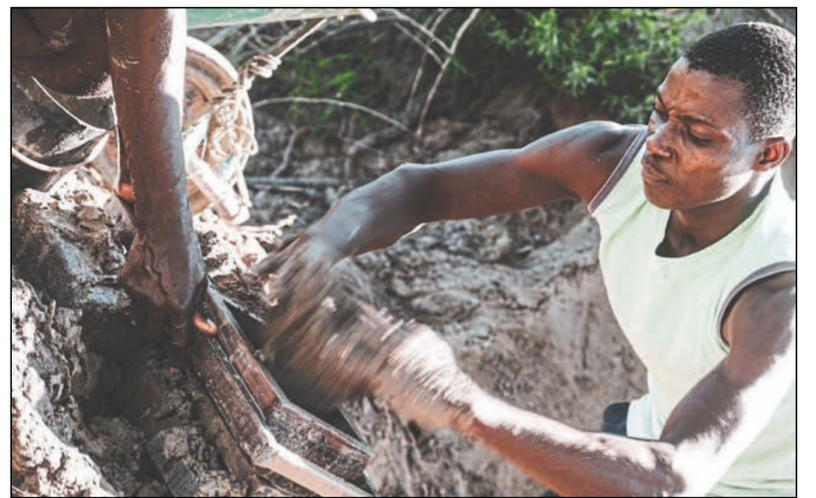
Feuchter, lehmhaltiger Boden wird in Formen gepresst und nach dem Trocknen schließlich zu den Ziegeln gebrannt, die für den Bau der Schule benötigt werden.
