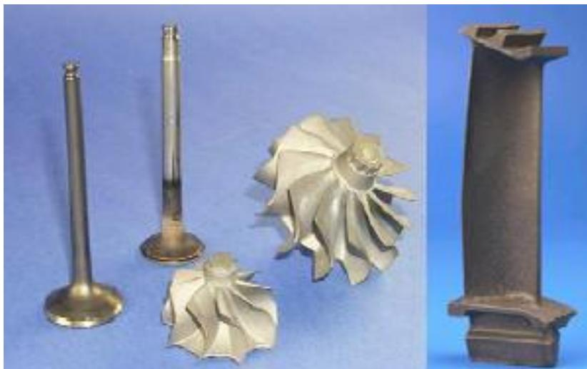
**Abbildung 2-2: Bauteile aus unterschiedlichen TiAl-Legierungen für den Einsatz in Verbrennungsmotoren und Flugtriebwerken; von links nach rechts: Auslassventile, Turboladerlaufräder und Turbinenschaufel (Smarsly, Bauer, et al. 2001)**
