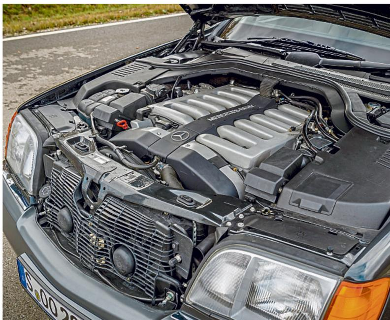
Kraft aus einem Dutzend: Am oberen Ende des Modellprogramms bot Mercedes den W 140 auch mit zwölf Zylindern an (Foto links).
