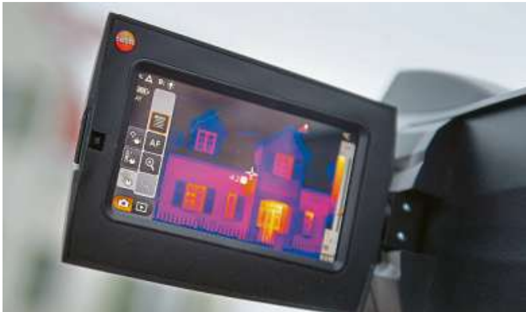
Den energetischen Zustand des Hauses untersuchen: Ein kalter Wintermorgen ist ideal für Aufnahmen mit einer Wärmebildkamera.
