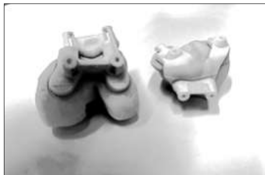
Ein Knie-Bausatz aus dem 3D-Drucker Foto: Dr. Steens
