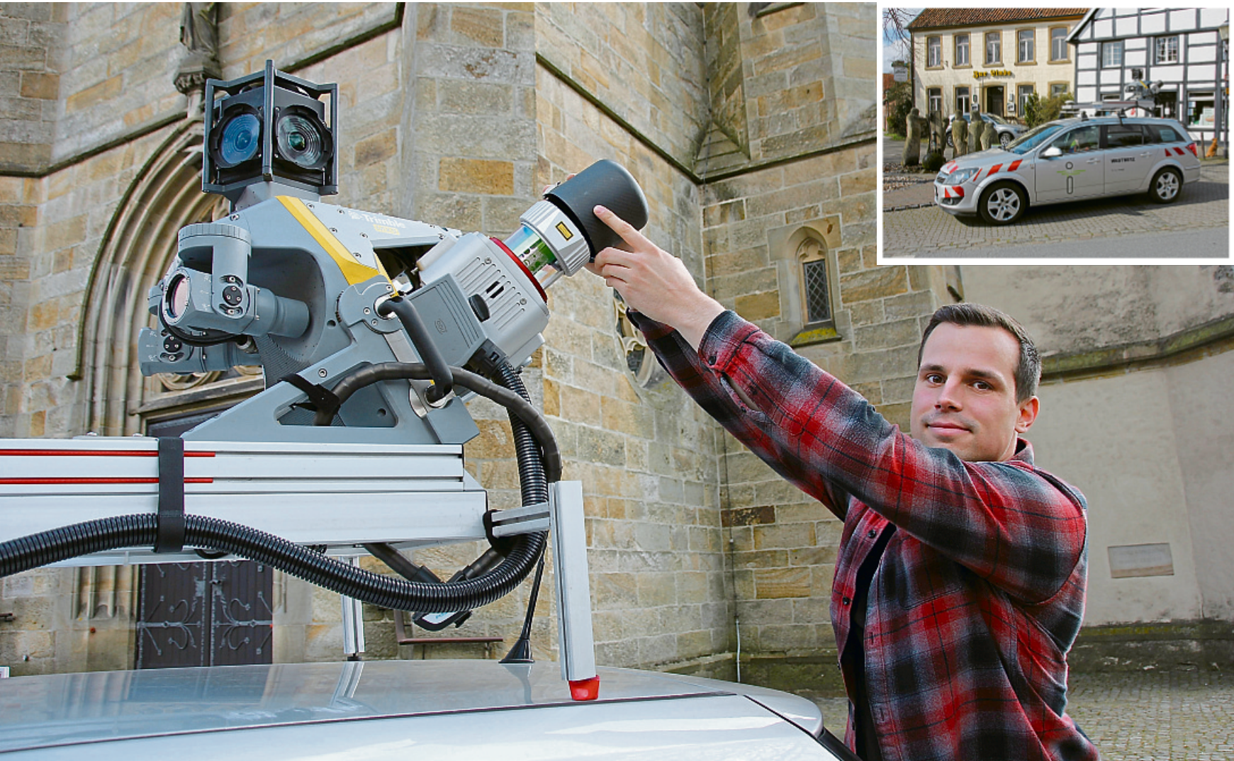
Patrick Ehlers entfernt die Schutzkappen vom Rotationslaser (oben) auf dem Dach des Spezialfahrzeugs (kl. Foto)
