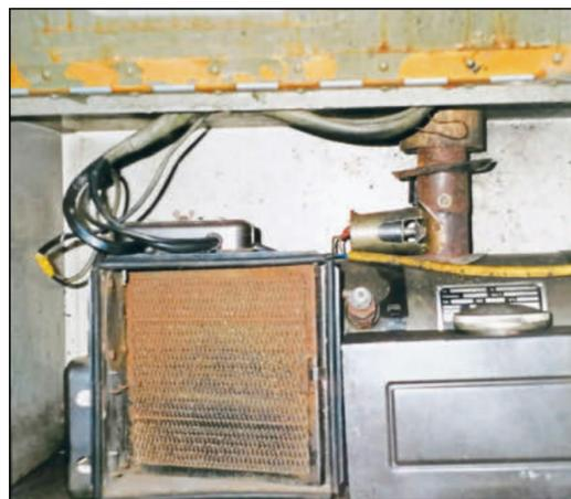
Ein eigener Diesel-Motor wärmt den Aufbau hinter der Fahrerkabine.
