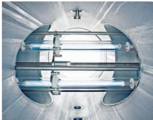
Diese Grafik des Herstellers ProMinent zeigt, wie eine UV-Anlage grundsätzlich aufgebaut ist: In einem Rohr sind UV-Lampen angebracht. Die bestrahlen das Wasser im Vorbeifließen. Die Stadtwerke nutzen die ProMinent-Technik in Scherfedehardehausen. Grafik: ProMinent GmbH
