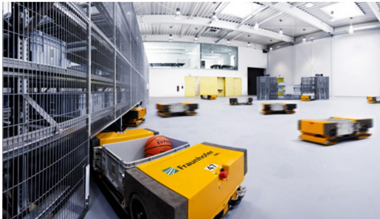
© Fraunhofer IML ZFT-Halle: Zellulare Fördertechnik mit autonomen Fahrzeugen
