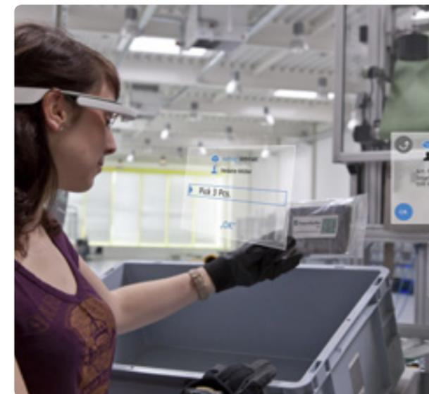
© Fraunhofer IML Kommissionieren mit Augmented Reality
