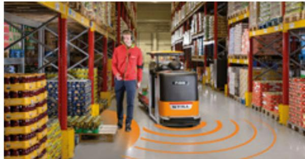
**Kommissionierfahrzeug, das sowohl manuell durch den Kommissionierer bedient wird, als auch selbstgesteuert fahren kann und dadurch den Kommissioniervorgang vereinfacht**
