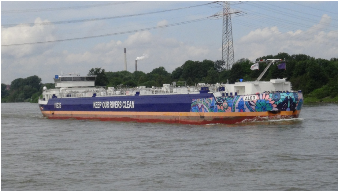
Abbildung 66: Ein neuer, mit LNG (flüssiges Methangas) betriebener Tanker auf dem Rhein bei Duisburg (Photo: D.Busch, LANUV)
