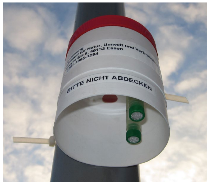
Abbildung 2: Passivsammler: Wetterschutzdose mit zwei eingesetzten Sammelröhrchen (Foto: LANUV NRW)
