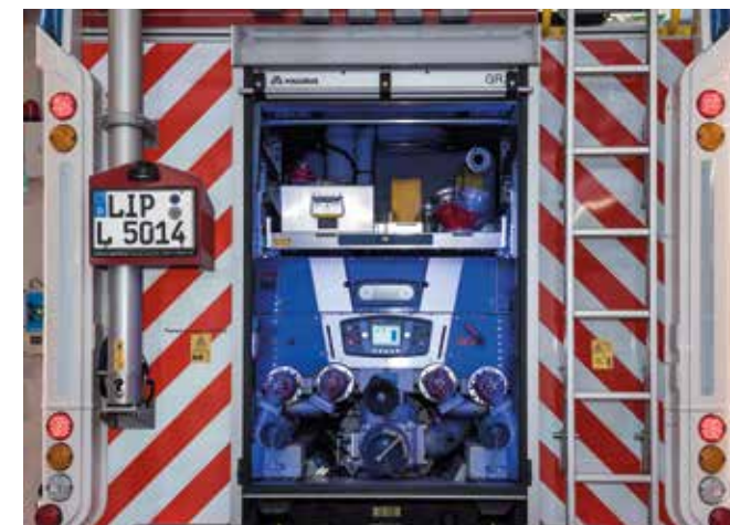
Pumpenstand des HLF 20 der Feuerwehr Lemgo
