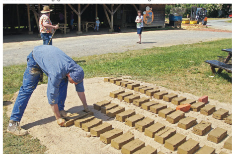
Ziegelerstellung im Handstrichverfahren. Ein geübter Ziegler stellte pro Stunde bis zu 200 Ziegel her, die vor dem Brennen mehrere Wochen an der Luft getrocknet wurden. Foto: wtl
