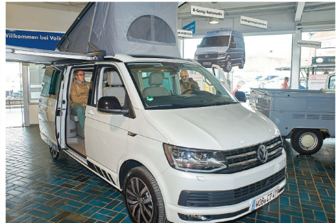
Der aktuelle Bulli T6 - hier als Reisemobil California in der Ausstattungsvariante Ocean mit raffinierter Einbauküche, elektrohydraulisch ausstellbarem Dach und Doppelverglasung. Bis zu vier Personen können im T6 California übernachten. Fotos: wl
