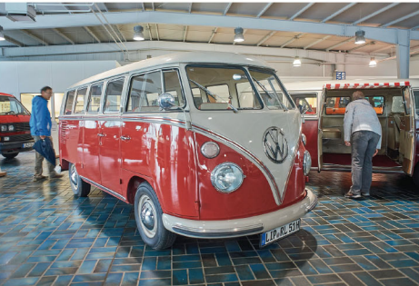
Ein Bulli T1 (erste Modellreihe), Baujahr 1967. Die T1-Reihe wurde bis 1967 gebaut. Einige Technik des T1 wurde vom VW Käfer übernommen, z.B. der Heckantrieb mit luftgekühltem 4-Zylinder-Boxermotor. Ganz charakteristisch ist die Stirn mit (Chrom-) Leisten und (Chrom-) VW-Emblem.
