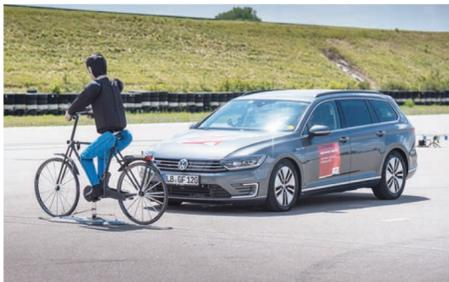
Im Fall der Fälle bremsst das Auto schneller als der Mensch reagieren könnte: Automatische Notbremsysteme befinden sich weiter auf dem Vormarsch. Foto: djd/Bosch
