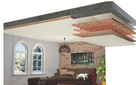
Elektrische Niedertemperatur-Flächenheizungen sind im Neubau oder in Gebäuden mit geringem Energiebedarf eine kostengünstige und effiziente Variante. Foto: rgz/www.argilla-therm.de
