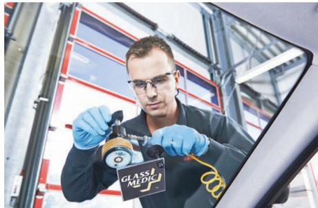
Eine Reparatur der Frontscheibe ist immer möglich, wenn der Steinschlag nicht größer ist als fünf Millimeter, keinen Riss gebildet hat und nicht im Sichtfeld des Fahrers liegt. Foto: djd/www.DEVK.de/Carglass
