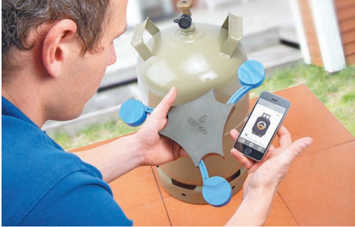
Die Füllstandsanzeige ist eine praktische Lösung für alle Nutzer von Gasflaschen: Mit Hilfe eines Messinstruments und einer App lässt sich genau verfolgen, wie viel Gas die Flasche noch enthält.
