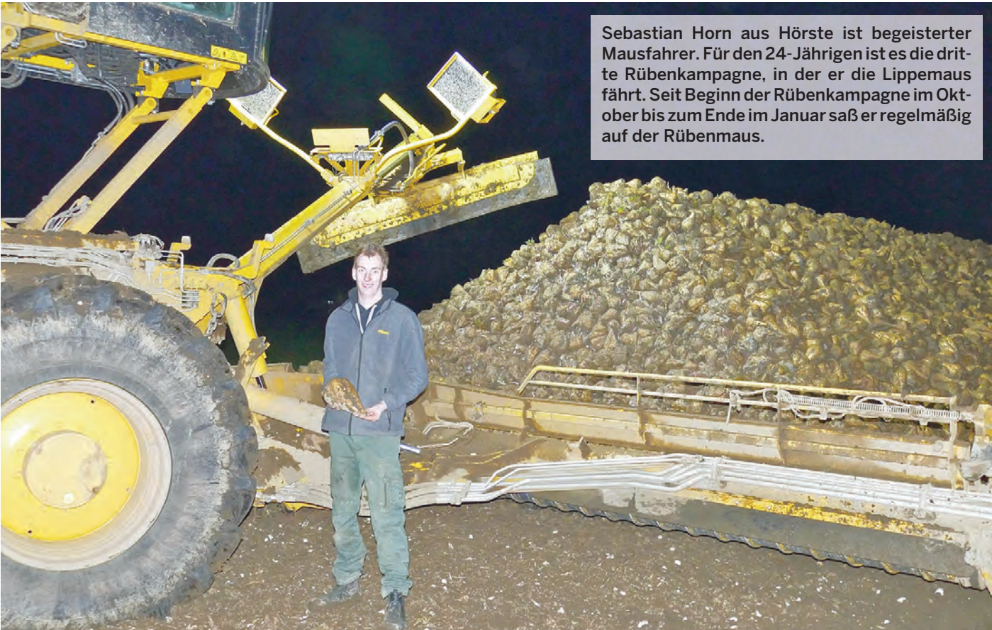
Das Ladegerät, die Rübenmaus, „frisst“ sich in den Rübenhaufen (wie hier auf dem Acker in Lemgo-Lieme) und befördert die Rüben auf den Transporter. Hierbei werden die Rüben schon grob von der anhaftenden Erde befreit. Anschließend geht es nach Lage zur Zuckerfabrik.
