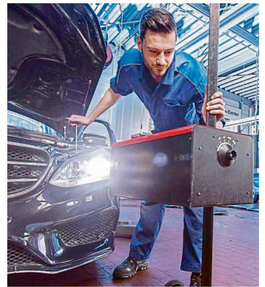
Im Licht-Test, den Kfz-Werkstätten in ganz Deutschland anbieten, werden alle Beleuchtungselemente des Fahrzeugs auf Einstellung und Funktion überprüft. Foto: djd/Kfzgewerbe/ProMotor/T. Volz
