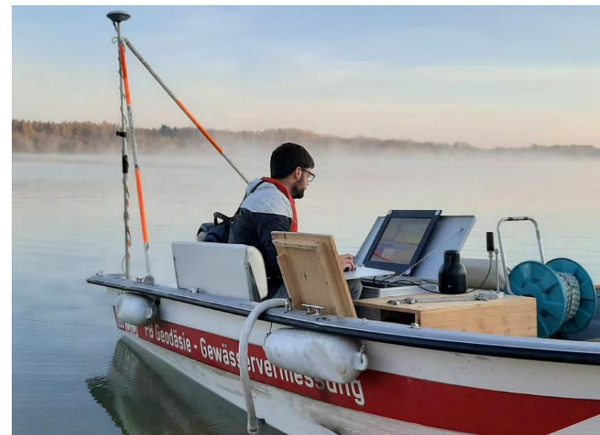
Das Messboot ermöglicht dem Fachbereich Geodäsie Gewässervermessungen
