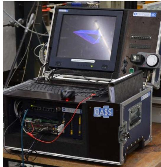
**Abbildung 2 QASS-Messgerät zur Körperschallmessung**
