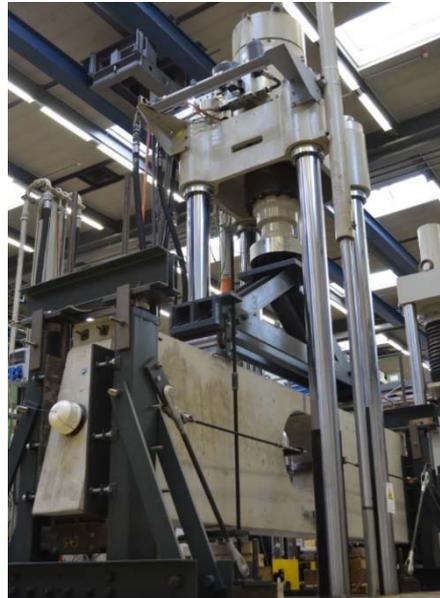
**Abbildung 1** Versuchsstand der Ermüdungsversuche aus, *Heinrich und Maurer (2019)*
