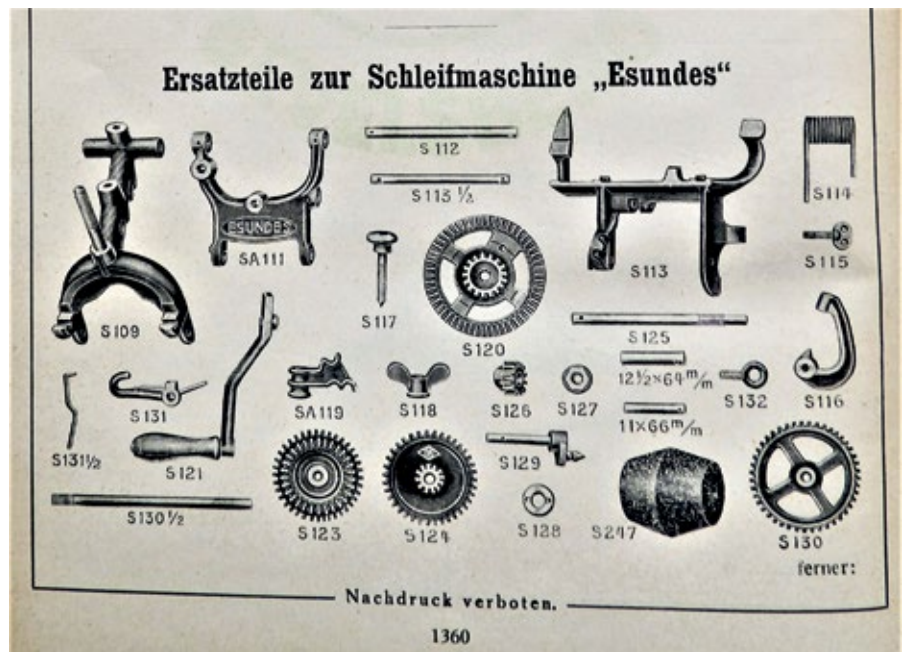
Das umfangreiche Ersatzteilkonvolut der Schleifmaschine „Esundes“ von Stockey & Schmitz im Hauptkatalog von 1927 mit anschaulichen Zeichnungen auf Seite 1360. (Sammlung Stadthistorisches Museum Ennepetal, Inventar-Nummer 2018-04-24-0084/Foto: Hubert Köhler)
