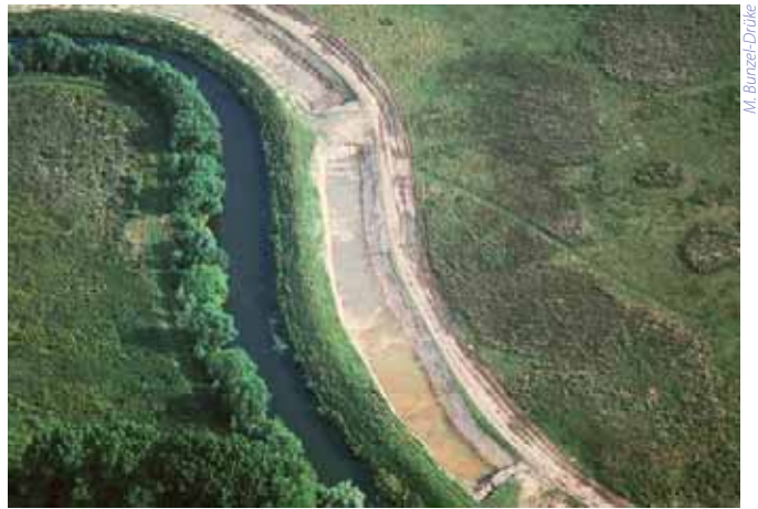
Aus der Luft wird der Umfang der Baumaßnahmen deutlich: links die Lippe mit dem unverändert bleibenden Innenufer, rechts der Mitteldamm, der Verbreiterungsgraben und die Baustraße.
