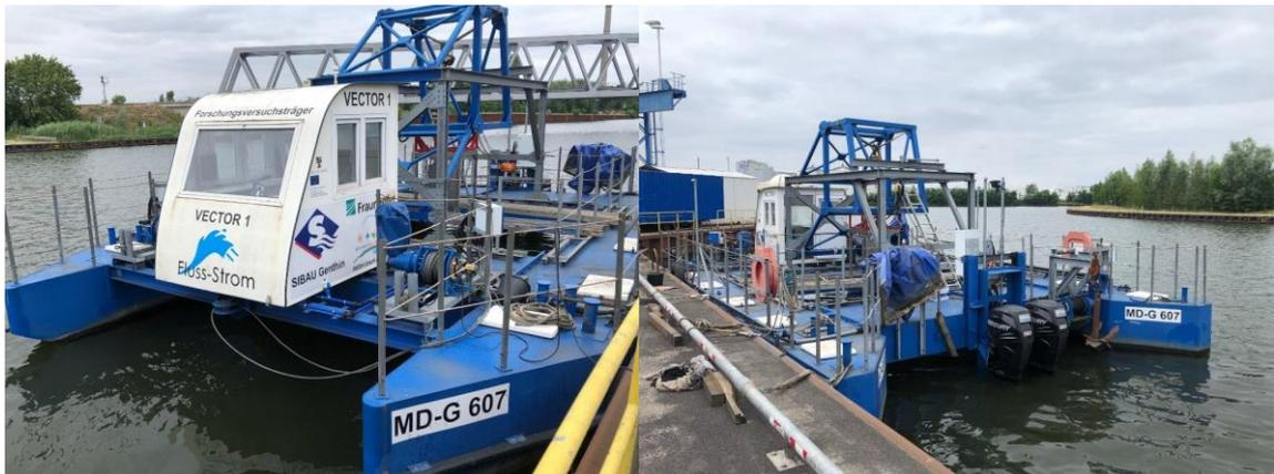
Abbildung 7-7: Forschungsversuchsträger VECTOR 1 mit Hebevorrichtung (blauer Rahmen) der Fa. SIBAU in Genthin
