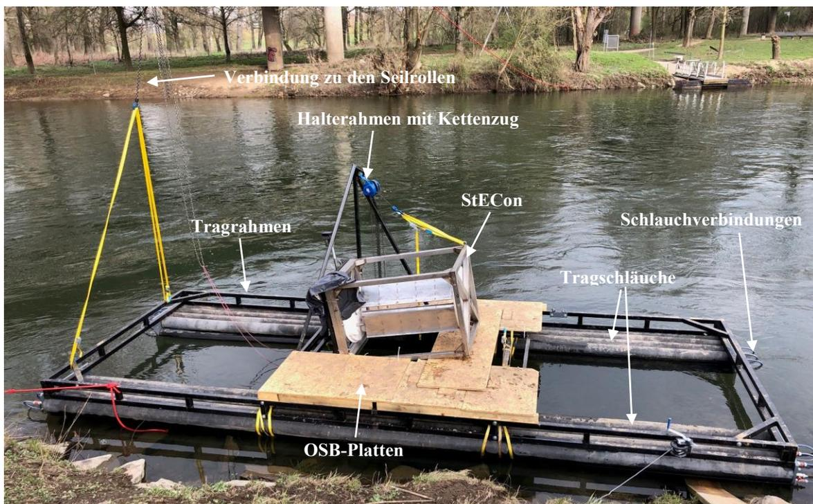
Abbildung 7-3: Schwimmende Versuchseinrichtung in Katamaran-Bauweise zur Untersuchung des StECon im freien Fließgewässer der Sieg mit dem installierten Prototyp StECon2
