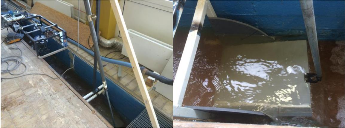
Abbildung A-2: Klappenstellung zur Regulierung des Wasserstands in der Versuchsrinne; Verstellmotor der Klappenstellung (links), Klappenmechanismus (rechts)
