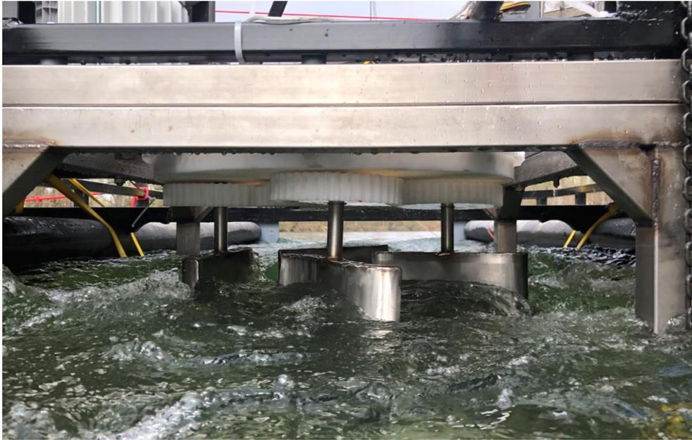
Abbildung 2-5: Prototyp des StECon (StECon2) in der freien Strömung des Fließgewässers Sieg
