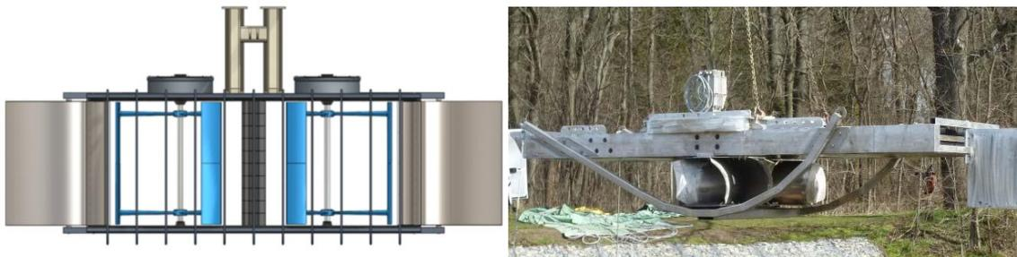
Abbildung 4-17: Schematische Darstellung des HydroQuest River 1.40 (links; HydroQuest, 2019), Horizontal<sup>2</sup>wasserrad (rechts; Barthel, 2018)
