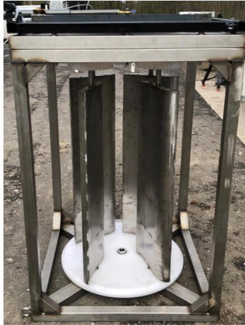
Abbildung 7-2: Zweiseitig gelagerter Prototyp StECon2 im Stahlrahmen mit S-förmigen Schaufeln aus Stahl (Jensen et al., 2020)
