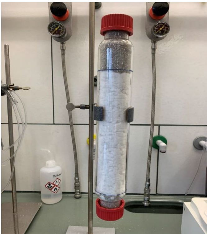
Abbildung 4: Säulenansatz mit einer Menge von 50 g an zerkleinertem, weißen Vlies
