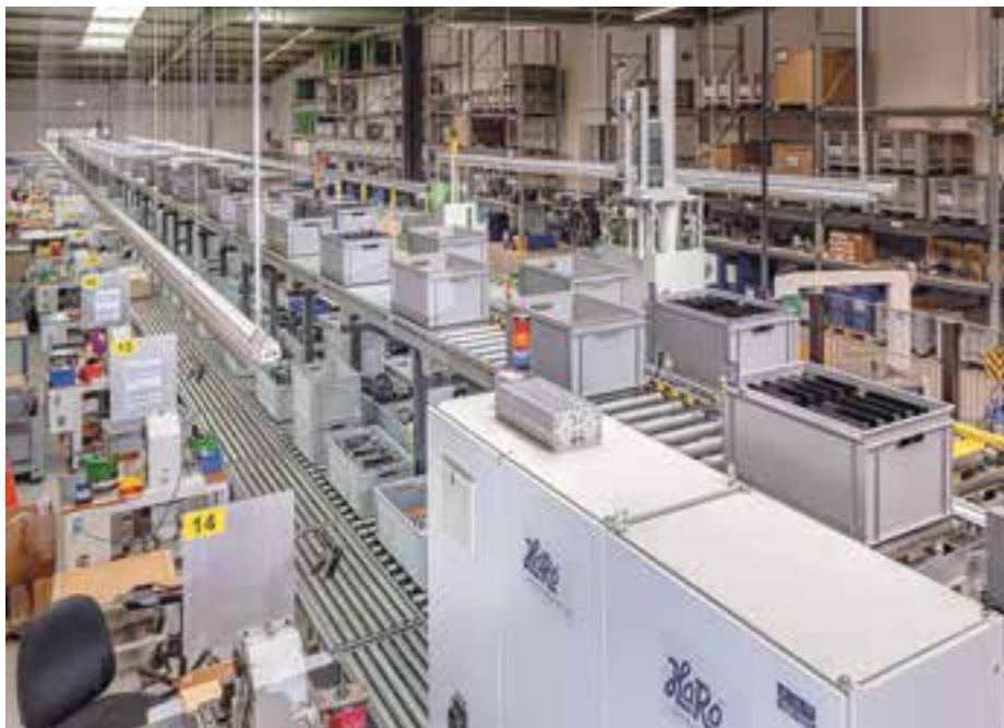
Rollenbahn für den KLT-Behältertransport auf zwei Etagen
