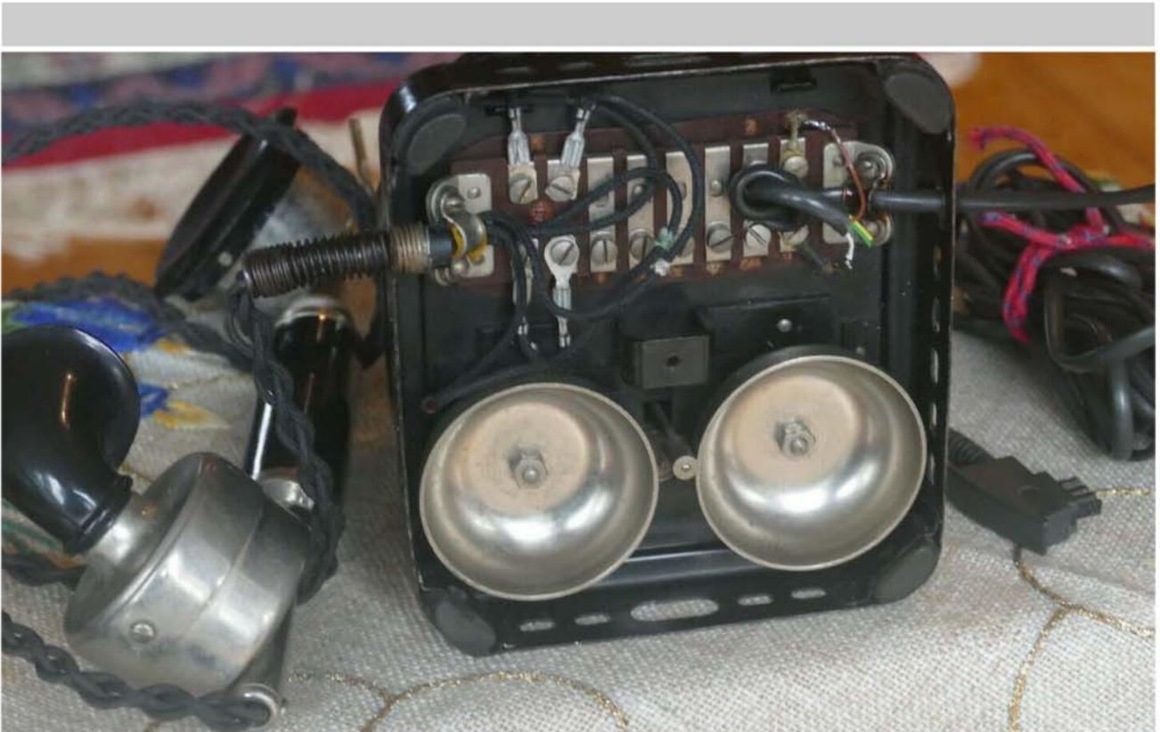
**Blick von unten auf die Klemmleiste für die Handapparate- und Anschlusschnur und Schalen des innen liegenden Wechselstromweckers ZB 26.**
