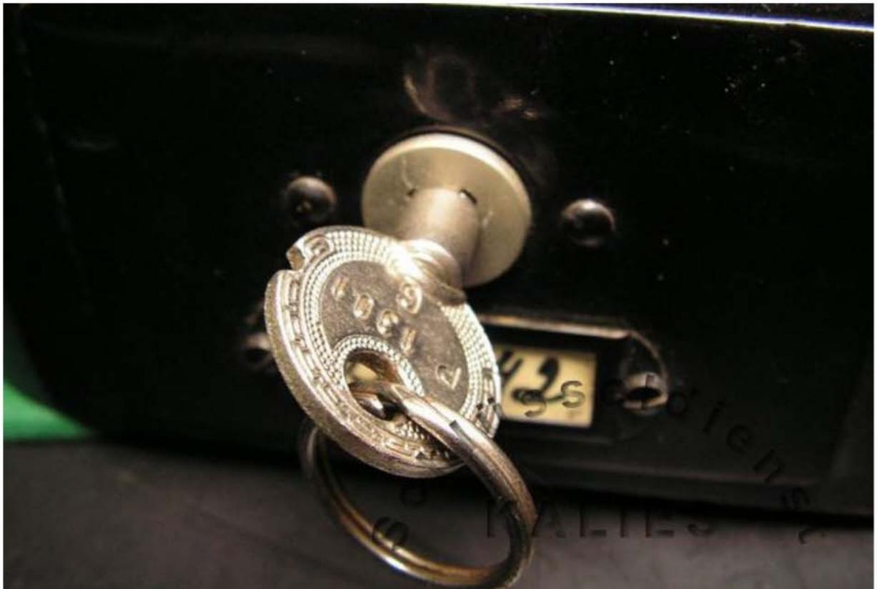
Das Schaltschloss ermöglichte dem Inhaber des Münzers und sk-Schlüssels das münzfreie Telefonieren. Der Münzer wurde in diesem Fall "frei geschaltet" und war wie ein gewöhnliches Telefon ohne Münzeinwurf bzw. Sperre der "0" zu benutzen.
