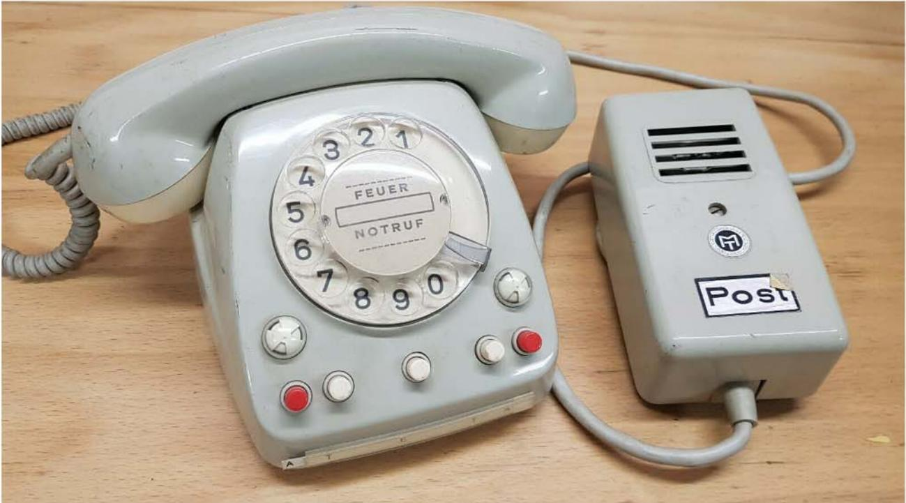
**Fernsprechapparat für 2 Leitungen: Rückfrageapparat RüAp 612**
