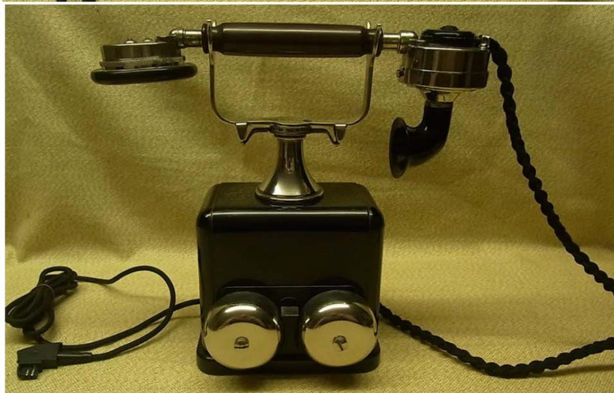
**Der hier vorgestellte Apparat, ZB/SA 19 E, gebaut von Siemens & Halske, ist mit einer neuen Anschlusschnur und dem dazu gehörendem Stecker ausgestattet. Er kann so über einen Adapter der die Wählpulse des Nummernschalters (Impulswahlverfahren (IWV) in Frequenzen (Mehrfrequenzwahlverfahren (MVF) umwandelt an das öffentliche Telefonnetz angeschlossen werden.**
