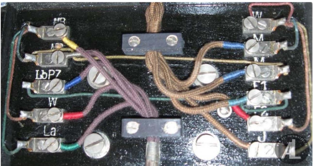
**Unterseite der Grundplatte mit den Klemmen für die Handapparate- und Anschlusschnur.**
