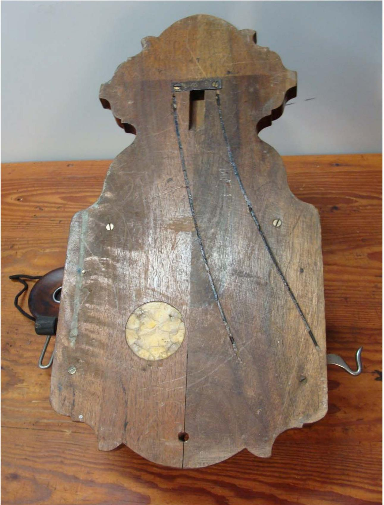
**Die Leitungen vom Kurbelinduktor und von der Klemme MK (Pluspol der Ortsbatterie) zum Mikrofon sind, wie auf dem Foto gut zu erkennen, in die Rückwand eingefügt.**
