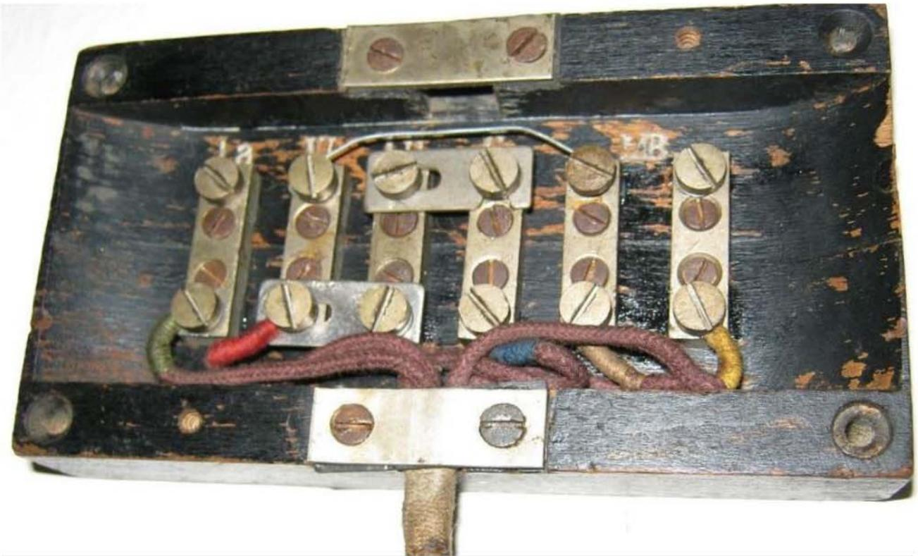
**Der Beikasten aus Holz wurde an der Wand befestigt und besaß einen Deckel aus Holz. An die im Bild obere Seite der Klemmen wurden die zur Vermittlung, zur Ortsbatterie und ggf. zu einem 2. Wecker führenden Leitungen angeschlossen, die unteren Klemmen wurden von der Schnur zum Apparat (Anschlusschnur) belegt.**
