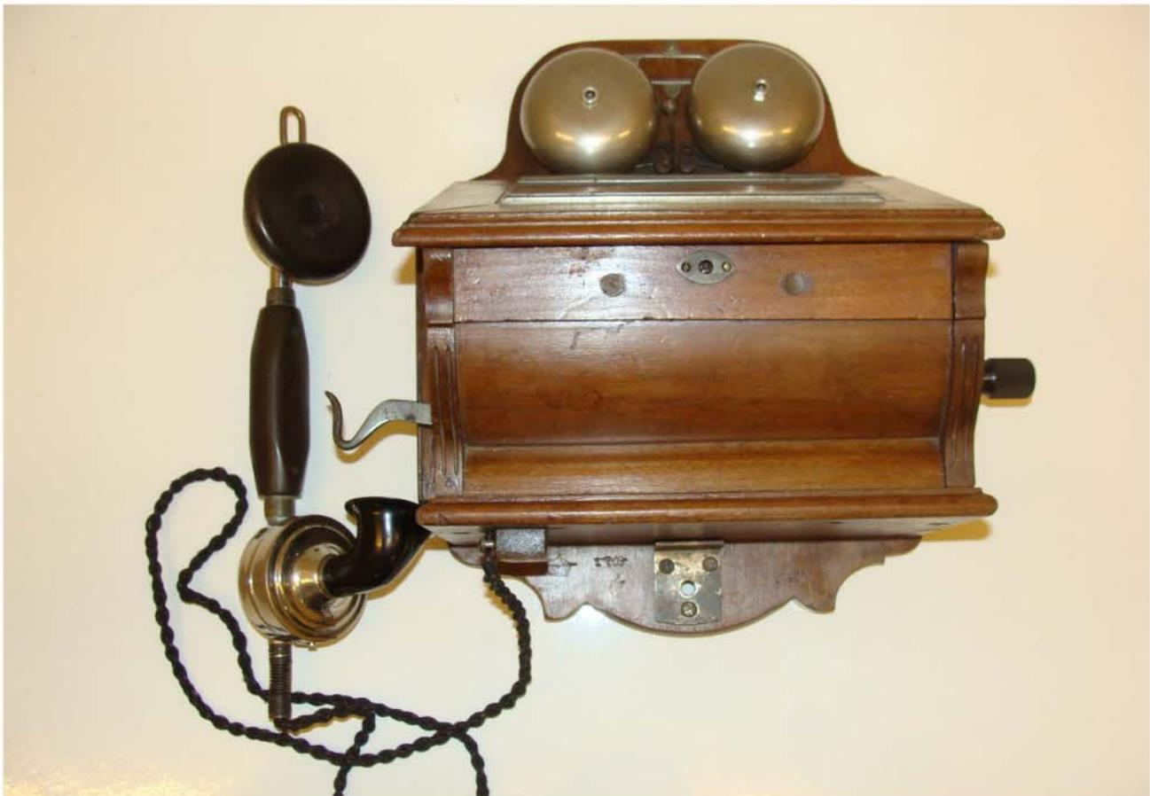
„Vater“ des hier und auf den nächsten Seiten vorgestellten Modells war ein StF 04. Kennzeichen: Pultabdeckung kann abgenommen werden, Kondensator für den Anschluss an Vermittlungsstellen mit selbsttätigen Schlusszeichen ist eingebaut (beim StF 03 nicht vorhanden).
