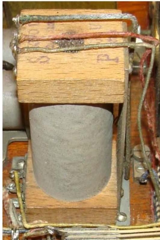
**Induktionsspule OB 20, älterer Bauart aus einem Fernsprechwandapparat OB 04.**
