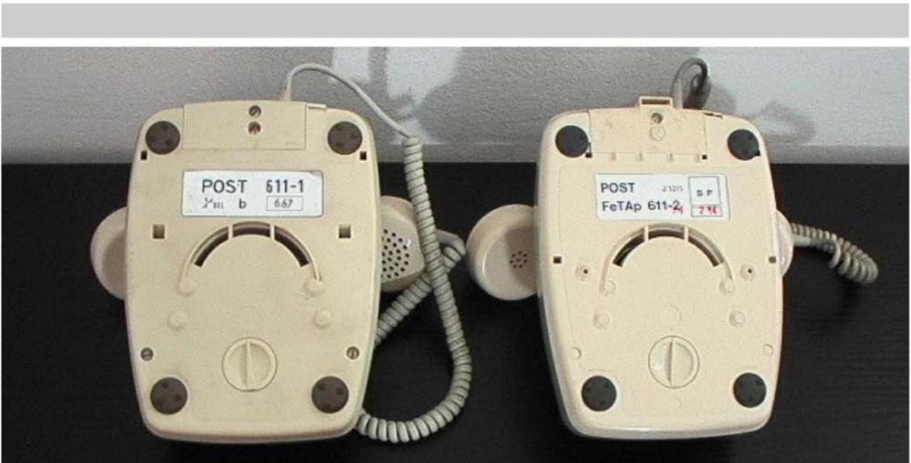
Ab 1968 wurde die Ausgabe 2 (FeTAp 611-2) eingeführt, die äußerlich geringfügige Änderungen aufwies. Man erkennt diese am besten an der Geräteunterseite. Die Abdeckung für die Anschlusschnüre hat nun hinten eine Lasche für die Halterung des Zusatzfernhörers. Außerdem ist der Blindstecker für den Zusatzfernörer nun erst nach Demontage der Abdeckplatte herausnehmbar.
