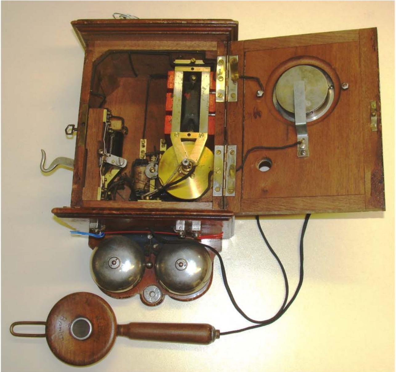
**OB Wandfernsprecher M 93 (Hersteller vermutlich Firma Gurlt) mit einem Stielfernrohr der Firma Gurlt. Die Schalen des Weckers sind unter dem Boden des Gehäuses angebracht.**
