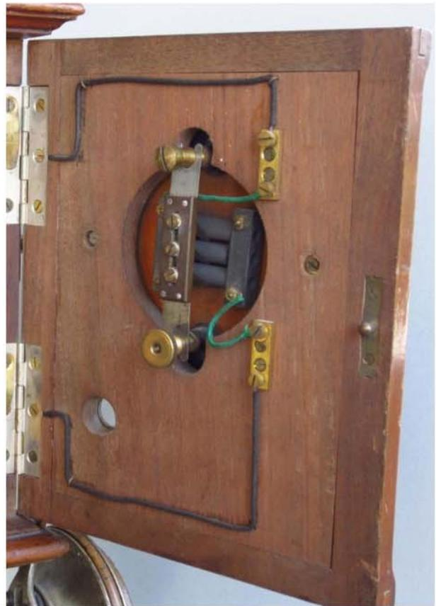
**Fernsprechwandapparat M 98 mit Fernhörer M 93. Schrankgehäuse der Reichstelegraphenverwaltung (RTV) mit Kohlenwalzenmikrophon in Holzrosette.**
