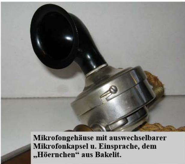
Mikrofongehäuse mit auswechselbarer Mikrofonkapsel u. Einsprache, dem „Hörnerchen“ aus Bakelit.
