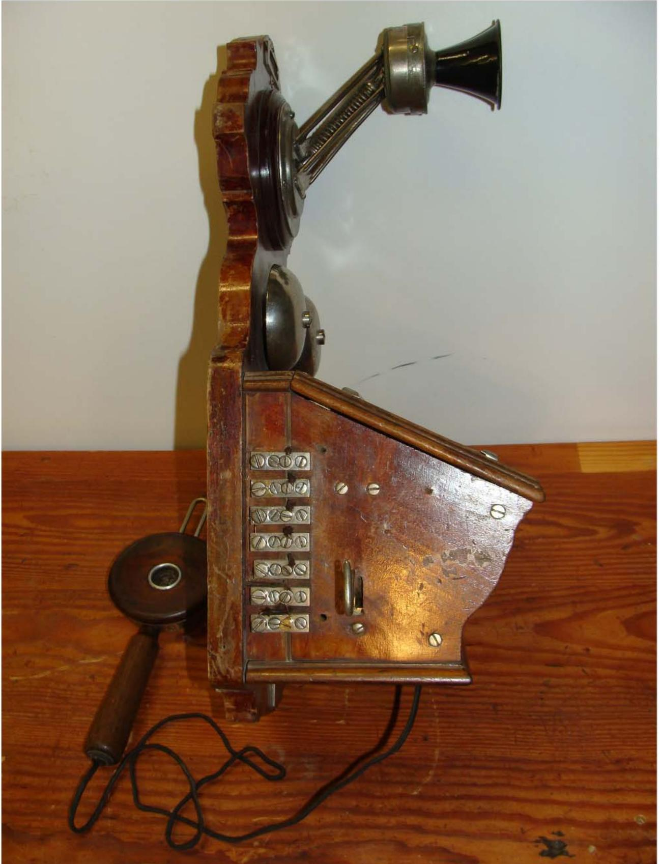
**Alle für die Anschaltung des Apparates benötigte Anschlussklemmen befinden sich außen rechts am Gehäuse.**
