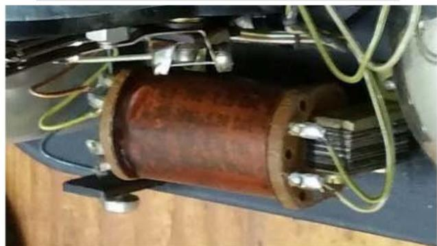
**Induktionsspule neuerer Bauart aus einem Fernsprechtischapparat OB 33.**
