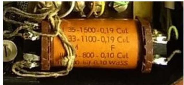
**Induktionsspule/Übertrager aus einem Fernsprechapparat W 28.**
