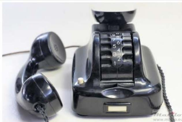
**Telefon von Siemens & Halske mit Trommelwählschalter**
