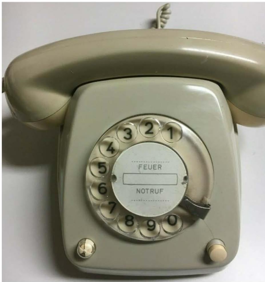
**FeTAp 616, mit Erdtaste und (eine Leitungsbelegung anzeigendem) Schauzeichen . Einsatz als erster Apparat bei A2-Schaltung.**
