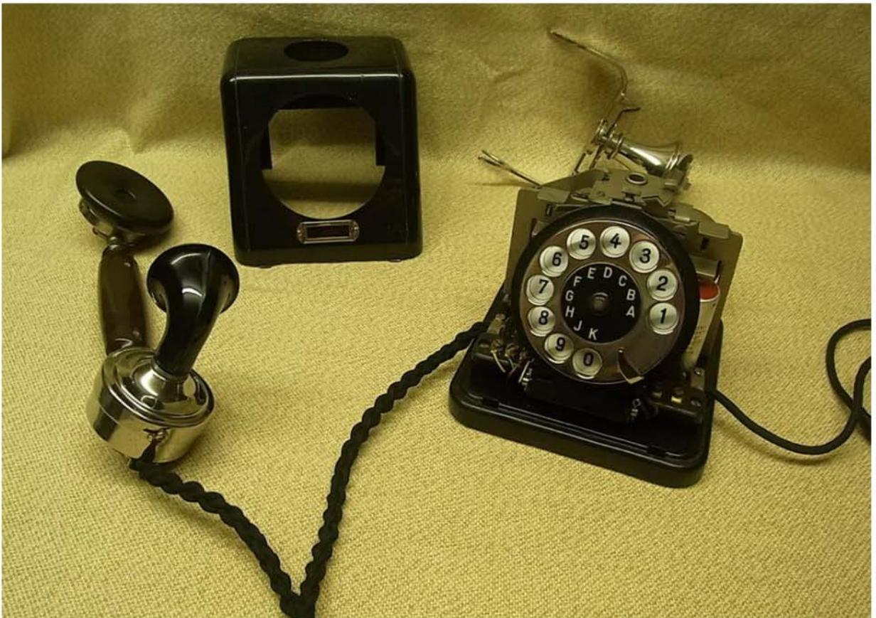
**Das Gehäuse kann ohne zusätzliches Werkzeug abgenommen werden, der Nummernschalter lässt sich nach vorne klappen. Damit sind alle Bauelemente leicht erreichbar.**
