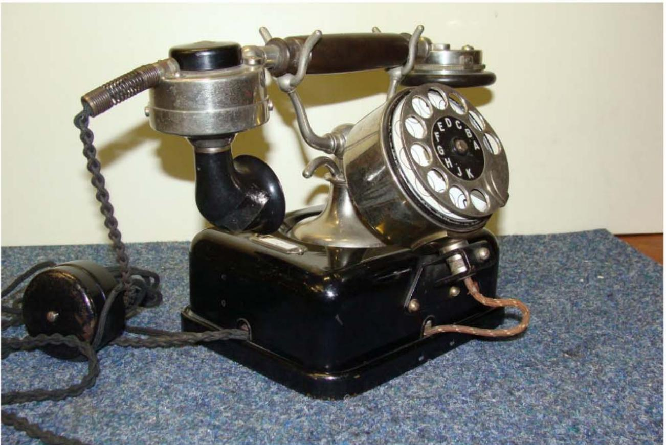
**Vorderansicht des Tischfernsprechers SA 08 mit aufgesetztem Nummernschalter.
