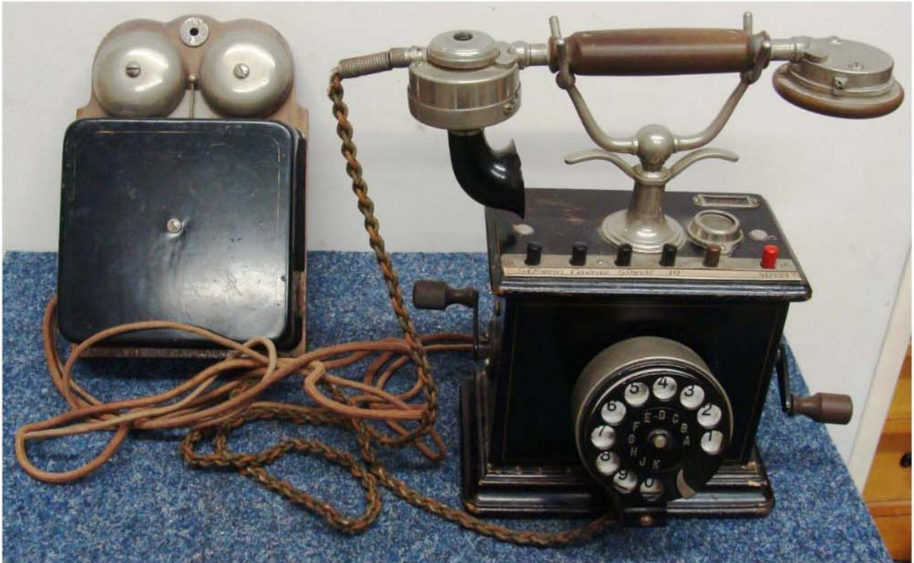
Reihenapparat ZBSplSA 10a mit Beikasten. 5 weitere Apparate konnten angeschlossen werden.
