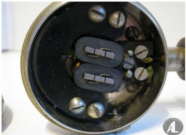
Das obere Foto zeigt den Boden des Mikrofongehäuses in das die Mikrofonkapsel eingelegt wird. Das untere Bild zeigt den Blick auf die Polschuhe der Hörkapsel bei abgenommener Hörmuschel (Membrane). Der Abstand zwischen Membrane und Polschuhen regelt grundsätzlich die Lautstärke der empfangenen Sprache. Beim Fernhörer ZB 06 ist der Abstand einstellbar. Dazu wird die Hörmuschel auf dem Gewinde der Fernhörerdose verstellt und dann fixiert.
