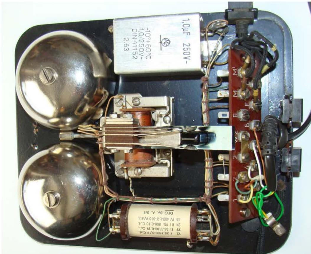
**Fernsprechapparat W 48: Blick ins Innere, oben mit, unten ohne Erdtaste.
