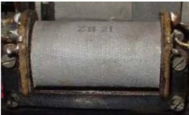
**Induktionsspule/Übertrager aus einem Fernsprechapparat ZB/SA 24.**
