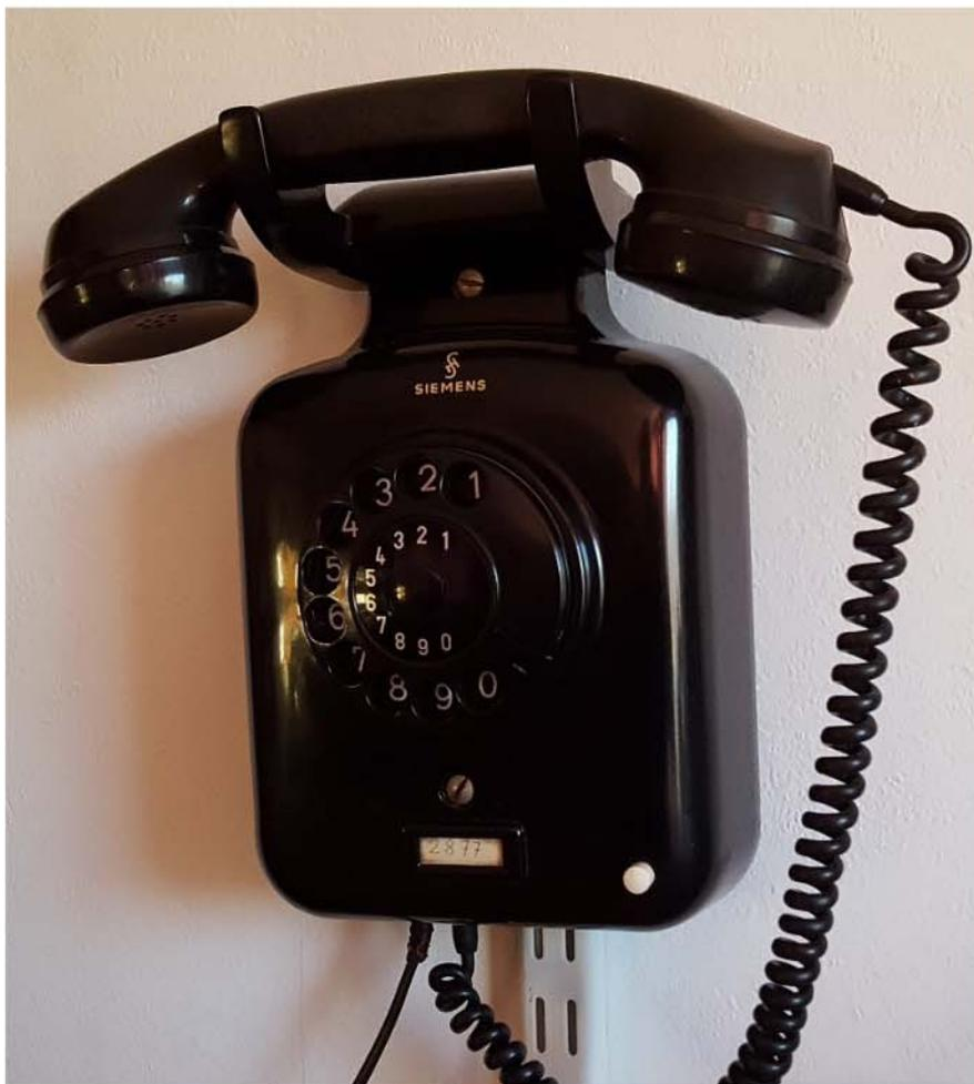
fonhörer Kabels sowie der zwei Gehäuseschrauben, musste wegen der Umbaufähigkeit des Apparates im Vergleich zum W 48 gekürzt werden. Ein weiterer Unterschied zum W 48 ist, dass das Schilderrähmchen für die Rufnummer zweimal vorhanden ist. Eines ist an der Stirnseite des Gehäuses und eines unterhalb des Gabelträgers angebracht.
