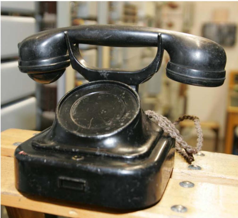
**W 28 Fernsprechapparat, zurückgebaut für den Einsatz im handvermittelten ZB-Betrieb.**
