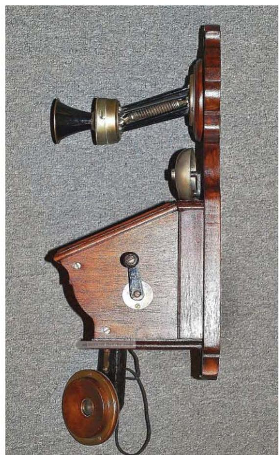
**Fernsprechwandapparat M00 von Siemens & Halske mit beweglicher Einsprache.**
