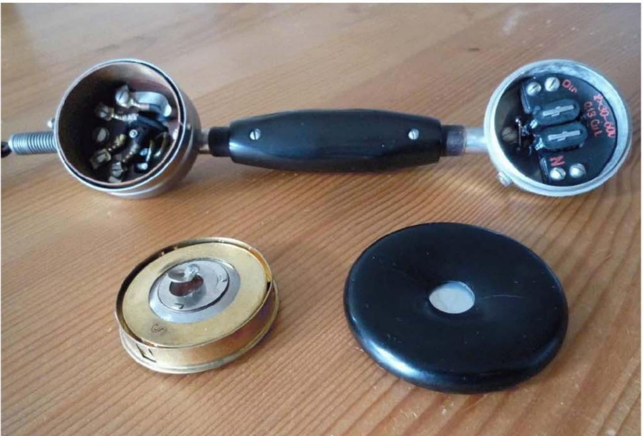
**Handapparat W24 mit dem Spulensystem ZB 06 im Fernhörer. Als Sprechkapseln konnten alle für den Wählbetrieb geeigneten Mikrofone verwendet werden.**
