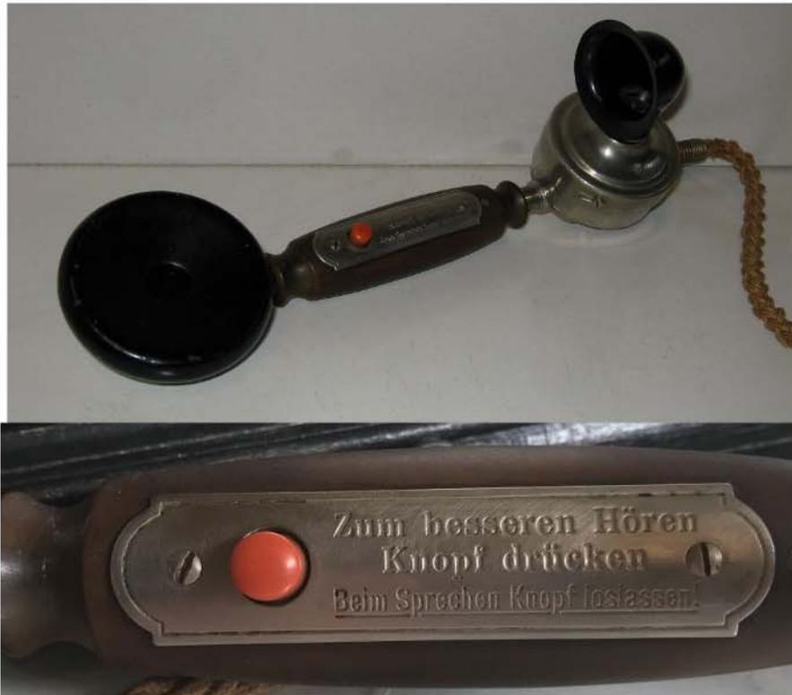
Der Handapparat hat bei einigen im OB-Betrieb verwendeten Apparaten einen Lauthörknopf. Er besteht aus einem Arbeitskontakt, der beim Drücken des Knopfes die Sekundärwicklung der Induktionsspule kurzschließt. Dadurch wird erreicht, dass für den ankommenden Sprechwechselstrom der Widerstand der Sekundärwicklung überbrückt wird. Die Hörwirkung im Fernhörer wird verbessert. Etwaige Störgeräusche aus der Umgebung des Sprechenden treffen zwar das Mikrophon, gelangen aber nicht in die Leitung.
