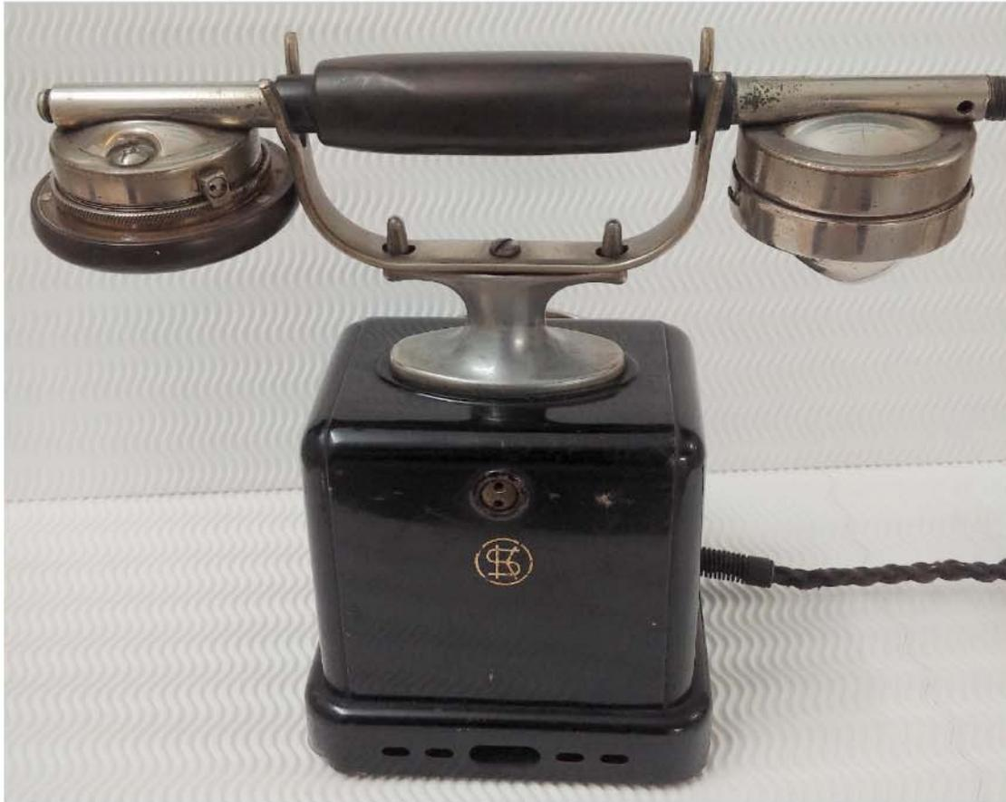
**ZB/SA 24 mit dem Handapparat 24 (flache, kreisrunde Hörmuschel und kugel- oder trichterförmige Mikrofon-Einsprache)**
