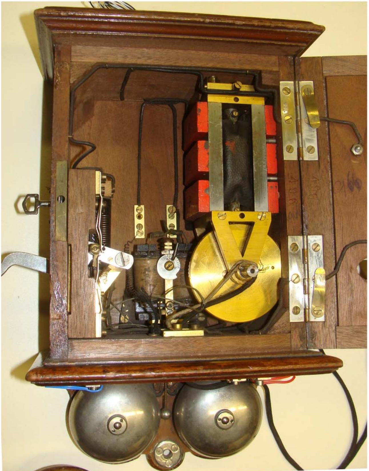
Der Blick ins Innere zeigt die üblichen Bauteile. Ein Spindelblitzableiter wie noch beim M 93 von Siemens & Halske ist nicht erkennbar. Der Überspannungsschutz musste demnach über ein besonderes Kästchen, das die nötigen Sicherungen enthielt, erfolgen.
