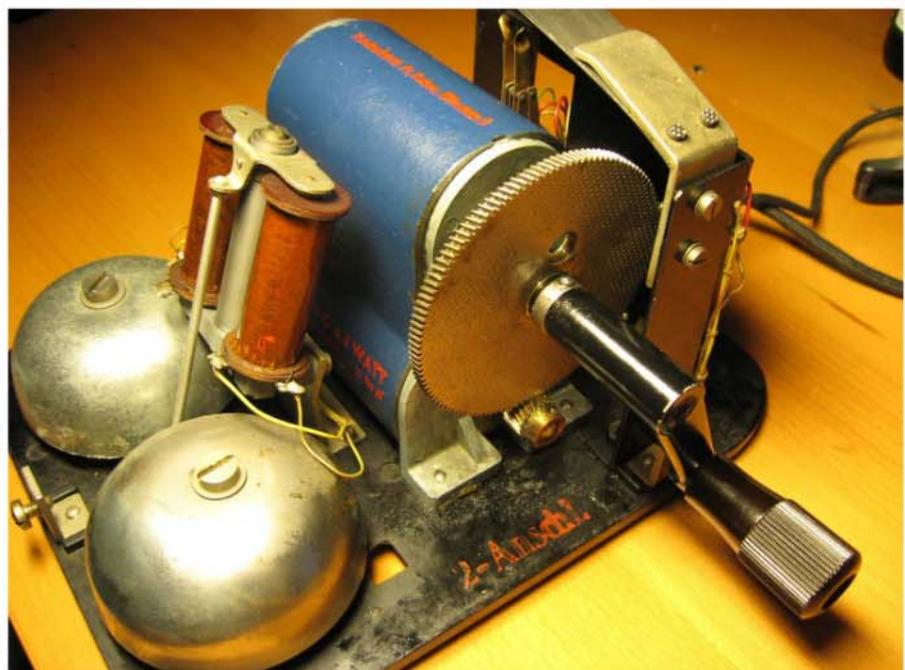
**Kurbelinduktor im Fernsprechtischapparat OB 33. Solche Kurbelinduktoren sind auch im Feldfernsprecher 33 und im Streckenfernsprecher SF 882 eingebaut.**
