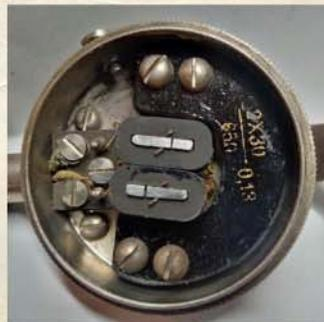
Der Fernhörer M 1900 enthält an Stelle des schweren Hufeisenmagneten ein System aus zwei halbringförmigen Scheibenmagneten, deren gleichnamige Pole einander zugekehrt sind, und die durch die Unterlegplatten der Polschuhe zu einem geschlossenen Ring vereinigt werden.
