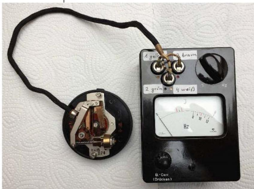
**Der Nummernschalter läuft mit der richtigen Geschwindigkeit ab, wenn der Frequenzmesser 10 Stromimpulse pro Sekunde anzeigt. Neben dem hier gezeigten „Telefon-Wählscheiben-Wählgerät“ konnten mit den Prüfströmen in den Vermittlungs- und Entstörungsstellen die**
