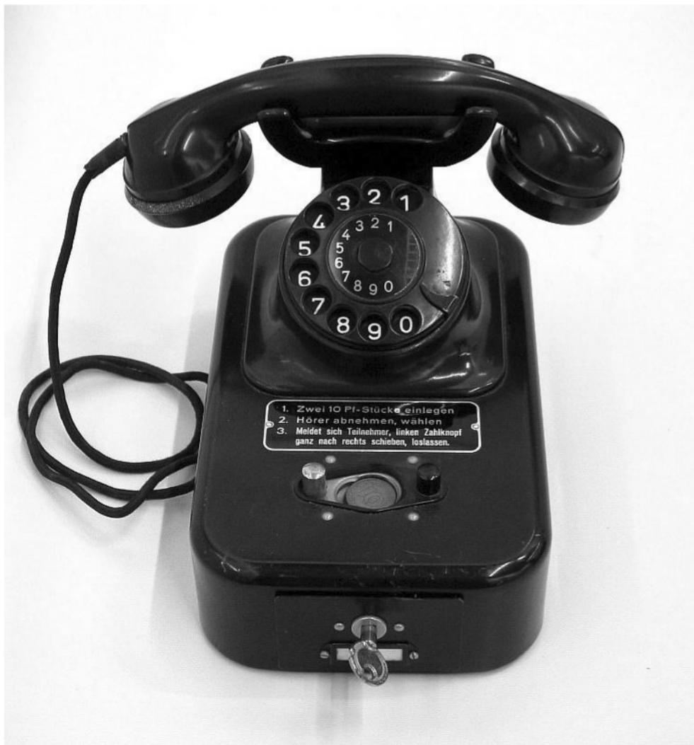
Verbindung bei Bedarf blockiert wurde (Sperrnummernschalter). Beim Wählen wurde ein dreiarbiges Hebel- und Kontaktwerk in Gang gesetzt, welches nacheinander die ersten drei Ziffern überprüfte. Dieser Typ Nummernschalter wurde auch bei den öffentlichen Münzfernsprechern verwendet und konnte durch Setzen von entsprechenden Lötbrücken konfiguriert werden, um auch kostenpflichtige Verbindungen zur manuellen Auslandsvermittlung oder Diensten wie Telex oder der Telegrammaufnahme zu verhindern.
