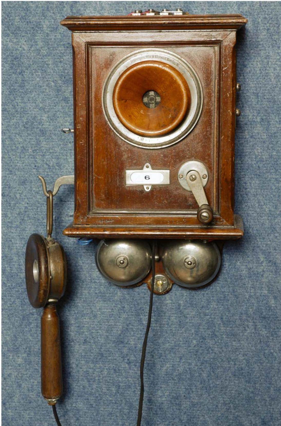
**OB Wandfernsprecher M 93 (Hersteller vermutlich Firma Gurlt)) mit einem Stielfernörer der Firma Gurlt. Die Schalen des Weckers sind unter dem Boden des Gehäuses angebracht.**
