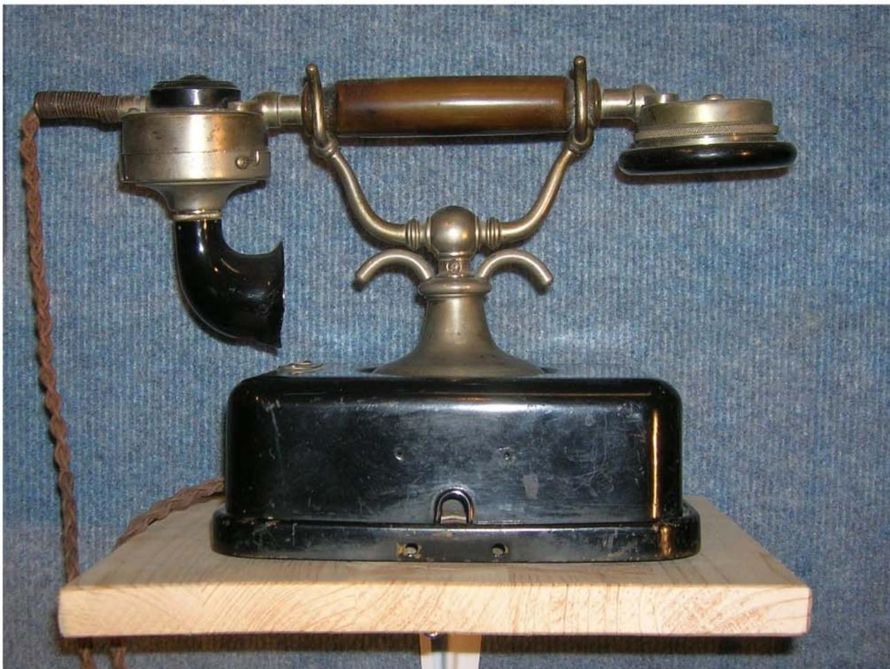
**Fernsprechtischgehäuse SA 08 im Blechgehäuse, vorbereitet für die Ausstattung mit einem Nummernschalter - dafür die Bohrungen und der Kabeldurchlass an der Vorderseite.**
