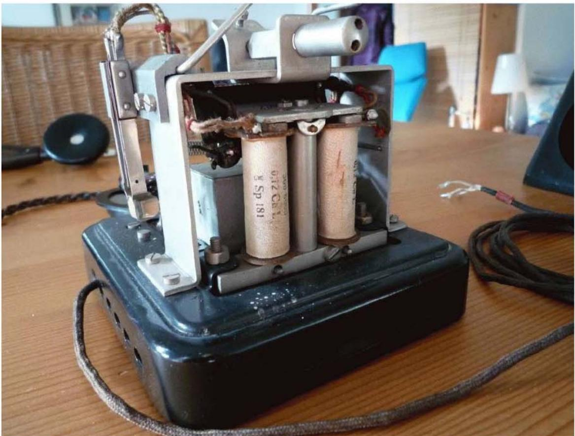
Die Spulen des Wechselstromweckers ZB 26 mit  $2 \times 300 \text{ Ohm}$ .
