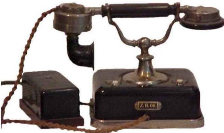
Der hier gezeigte ZB 08 ist nicht im Originalzustand. Es fehlt der Beikasten und die ursprüngliche Anschlusschnur ist durch eine Kunststoffschnur und eine neuere Anschlussdose ersetzt.
