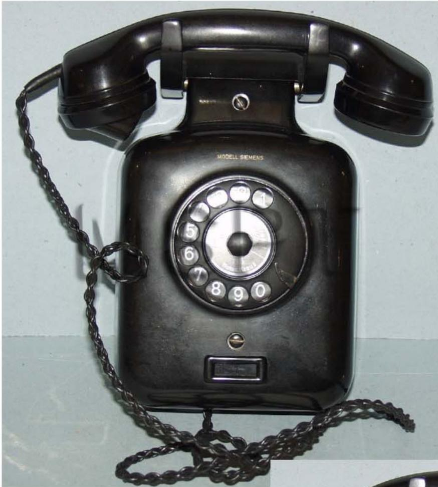
**Oben: Fernsprechwandapparat W 38.**
