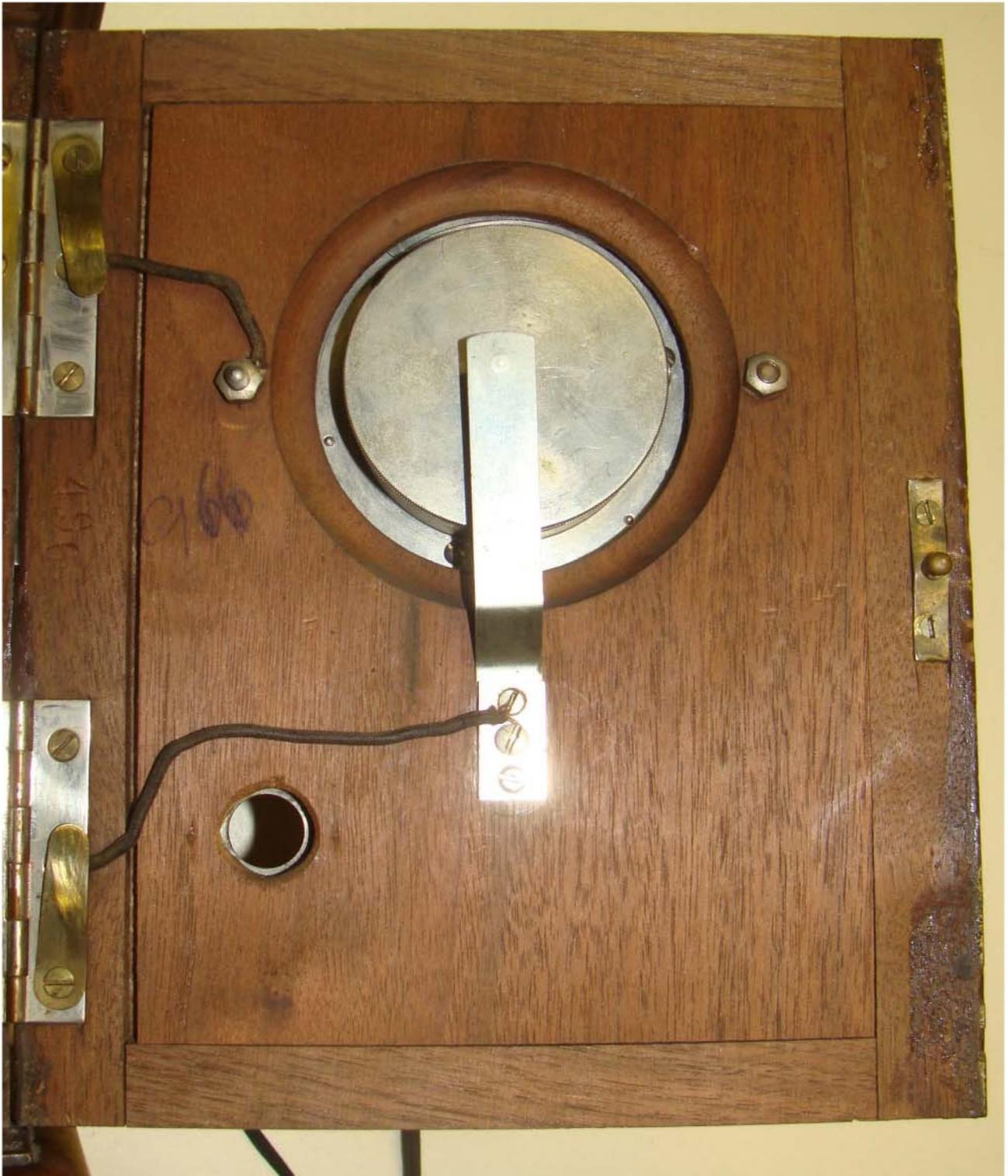
**Das auswechselbare Mikrofon in der Tür ist, wie beim M 93 von Siemens & Halske, über die Scharniere der Tür angeschlossen.**
