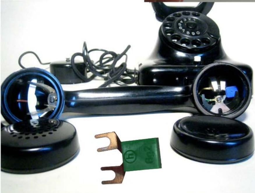
**Handapparat eines W 48: Gehörschutzgleichrichter in der Hörerkapsel.**
