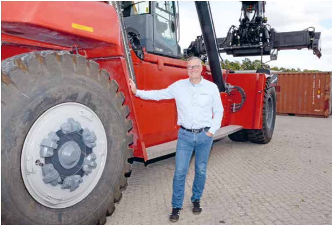
Gewichtige Investition Kai Scheffler hat für seine Container-Dienstleistungen einen Reach-Stacker, einen Container-Stapler, angeschafft. Das Arbeitsgerät bringt 76 Tonnen auf die Waage.
