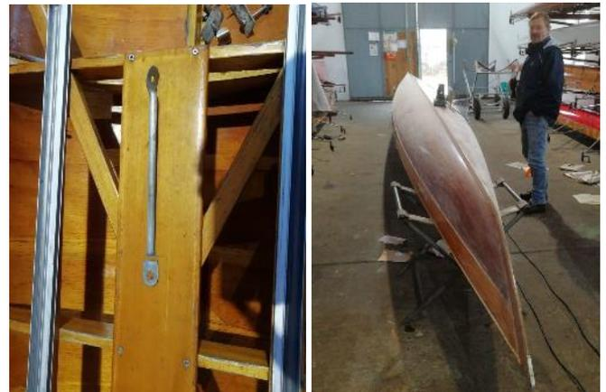
Neu geschweißter Verbinder und fachmännische Abnahme des Zwischenschritts: Kann nach dem Schliff lackiert werden?
