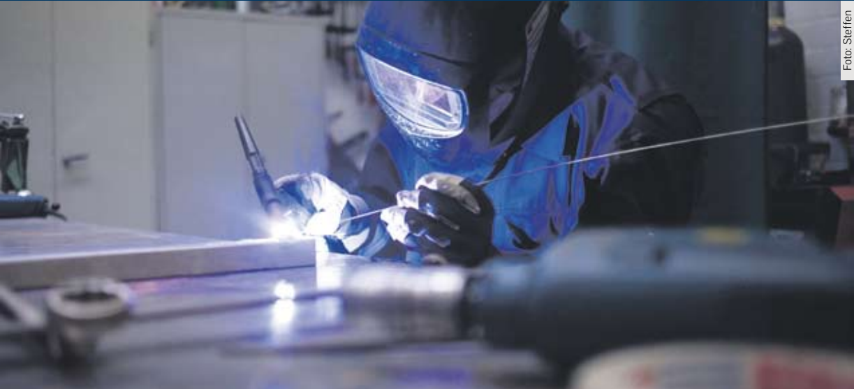
Das sog. WIG-Schweißen gehört zur Ausbildung, es verursacht wenig Spritzer und belastet die Gesundheit relativ gering.
