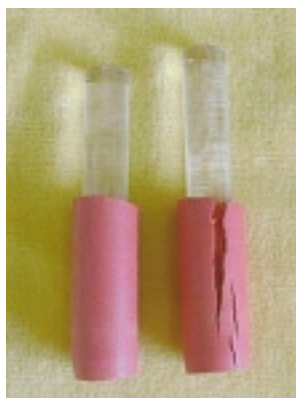
Gummischlauch vor und nach Ozoneinwirkung
