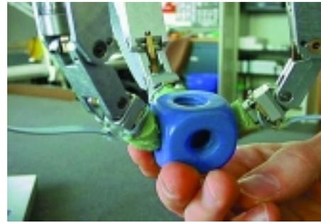
Abbildung 8: Roboterfinger: Eine enge Mensch-Roboter-Kooperation muss über den Sehsinn hinaus zusätzliche Sinnesmodalitäten berücksichtigen. In der Arbeitsgruppe Neuroinformatik entwickelte Tastsensoren verleihen der hier abgebildeten Roboterhand „Fingerspitzengefühl“, das der Hand ein gefügiges Reagieren ermöglicht, wenn der Mensch auf das Objekt zugreifen möchte.
