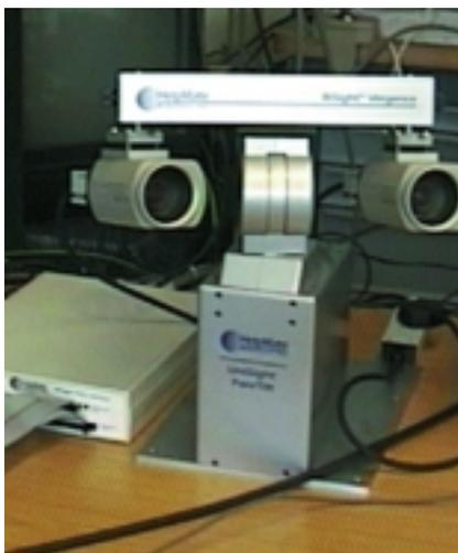
Abbildung 2: Ein computer-gesteuerter Binokular-Kamerakopf zur technischen Nachbildung „aktiven Sehens“: damit wird es dem Roboter möglich, seine Umgebung durch selbstgesteuerte Blickbewegungen visuell zu explorieren und seine Aufmerksamkeit auf wichtige Bildregionen zu fokussieren.
